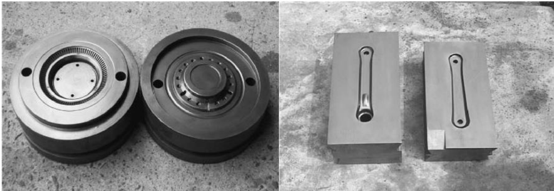
Şekil 2.2. Dövme işleminde kullanılan çalışma kalıpları (Chang ve diğ., 2008).
