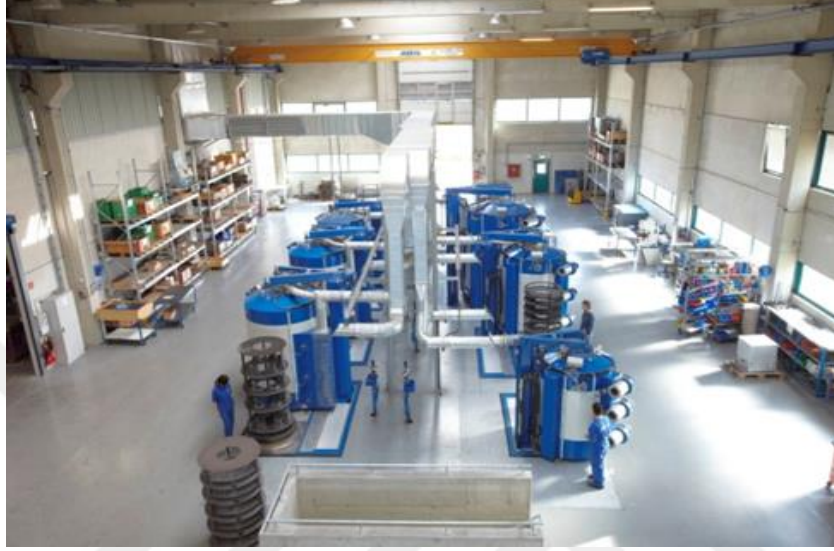
Şekil 3.4. Endüstriyel bir plazma nitrasyon ünitesi (Czerwinski, 2012).
