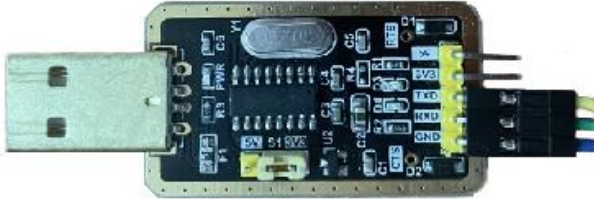
Şekil 3.9. RS232 USB-TTL seri haberleşme dönüştürücü modülünün üstten görünüşü
