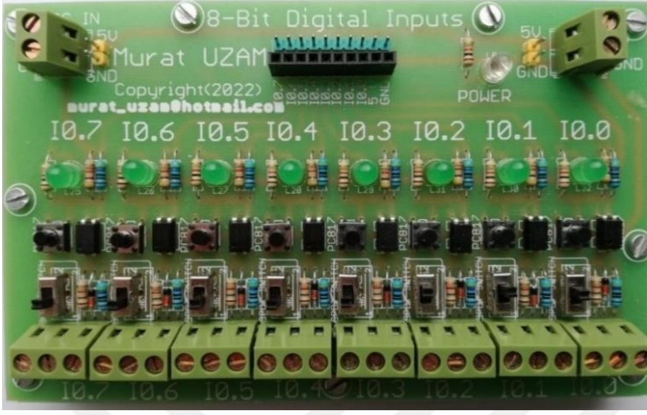
Şekil 3.5. 8 bit dijital PLC giriş kartının üstten görünüşü
