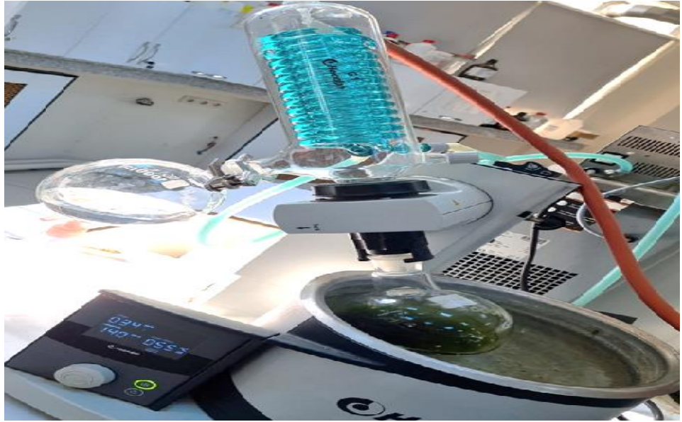
Resim 4. Medicago sativa tozlarının alkolik özütünün rotari evaporatör ile ayrıştırılması.
