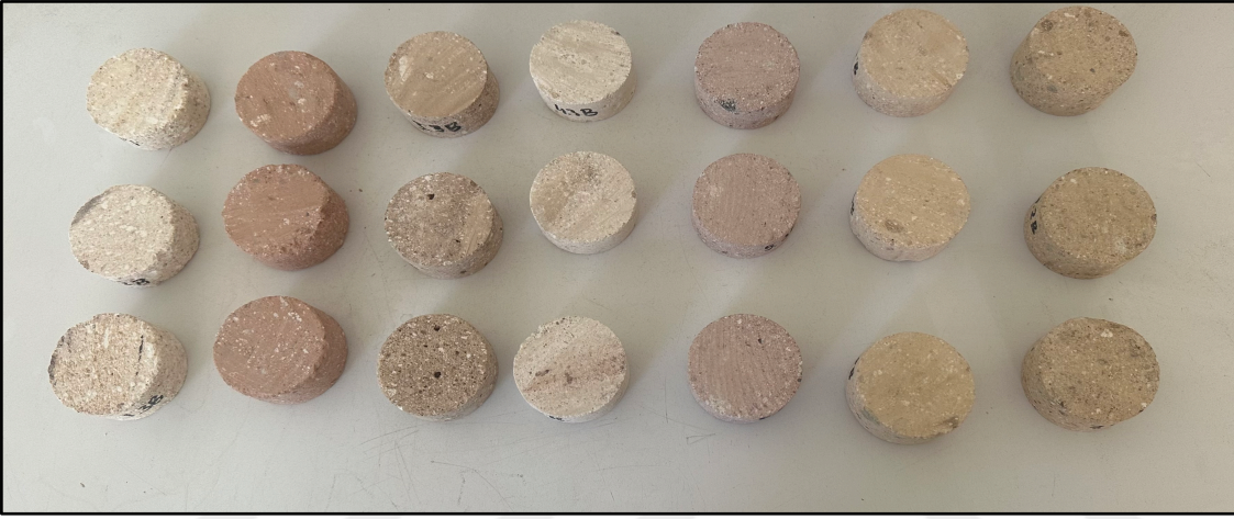
Şekil 4. 2. 7 farklı ignimbirit örneğinden alınan NX çaplı (54.7 mm) karotların bir kısmından görünüm.
