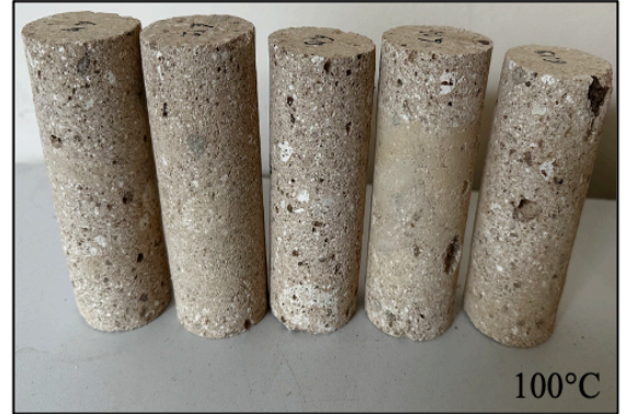
EK-1f: İgnimbirit 6 örneğine ait 0-1000°C arasındaki renk değişimini gösteren fotoğraflar.
