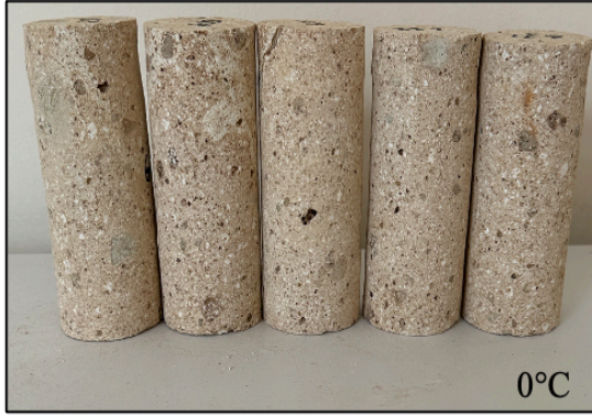
EK-1f: İgnimbirit 6 örneğine ait 0-1000°C arasındaki renk değişimini gösteren fotoğraflar.
