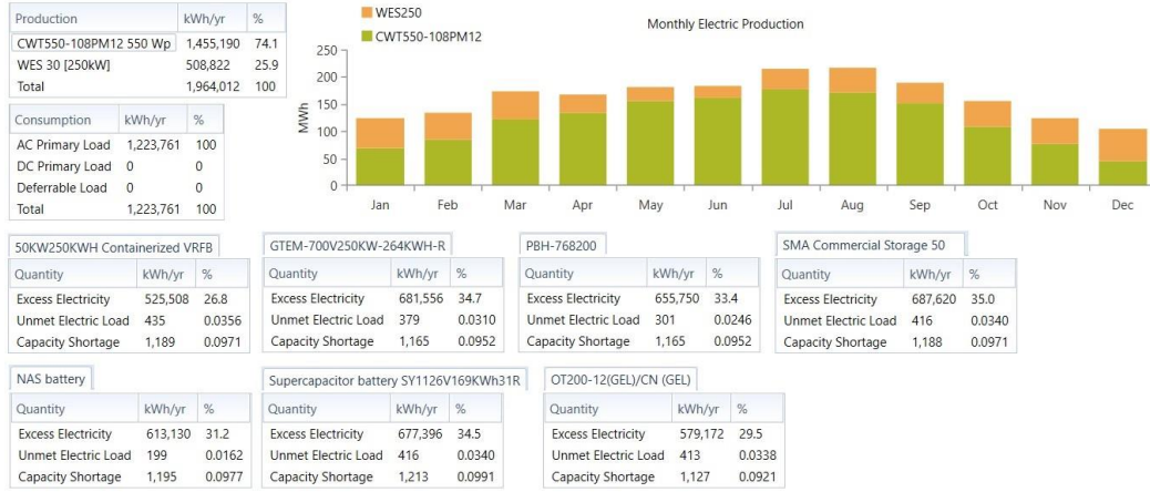
Şekil 4.12 Senaryo 2 üretim, tüketim ve farklı depolama sistemlerine göre aşırı elektrik verileri
