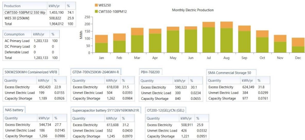
Şekil 4.10 Senaryo 1 üretim, tüketim ve farklı depolama sistemlerine göre aşırı elektrik verileri
