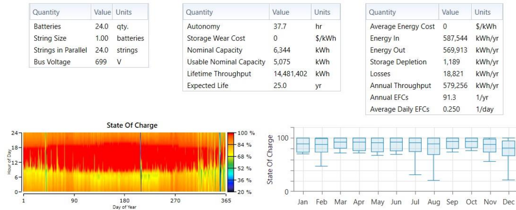
Şekil 4.40 Katı hal bataryası teknik sonuçları
