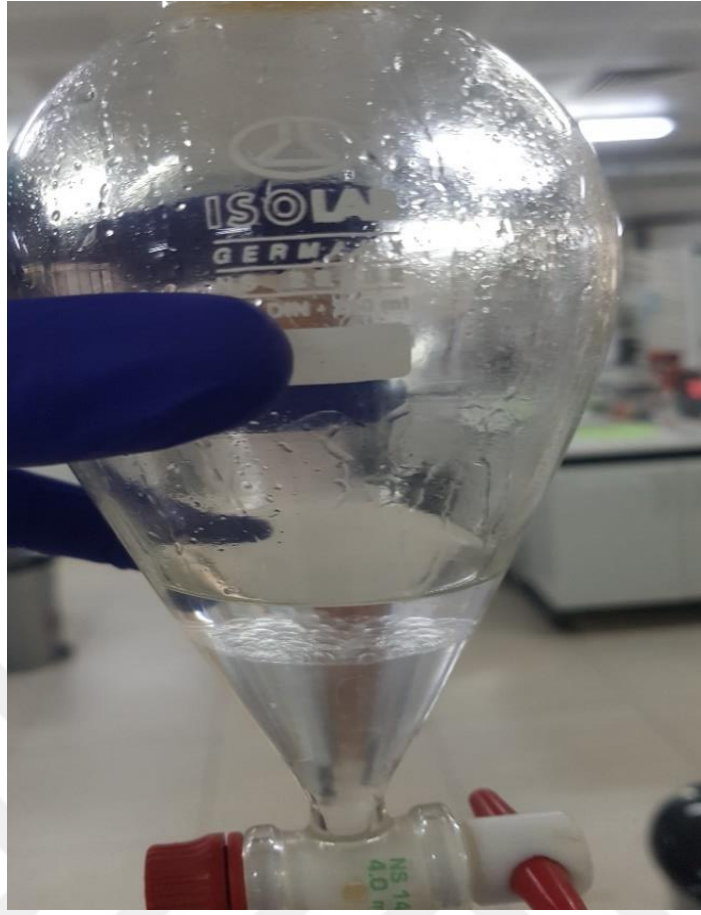
Şekil 15. GC-MS analizi için ekstraksiyon işlemi.
