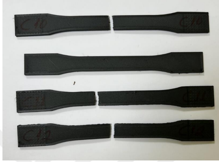
Şekil 2.14: Çekme test öncesi ve sonrası boy uzama farkı kıyaslama.
