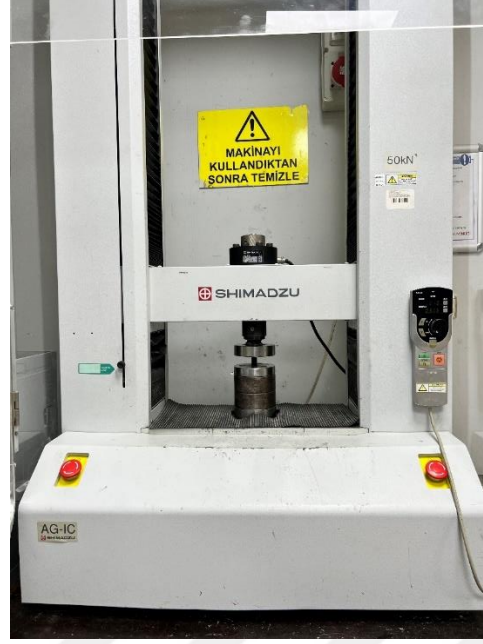
Şekil 2.16: Shimadzu 50kN test cihazı.
