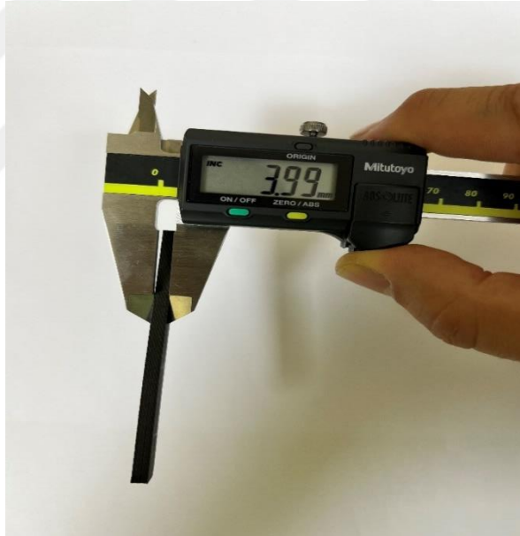
Şekil 2.11: Dijital kumpasla 3 nokta eğme numunesi et kalınlığı kontrolü.
