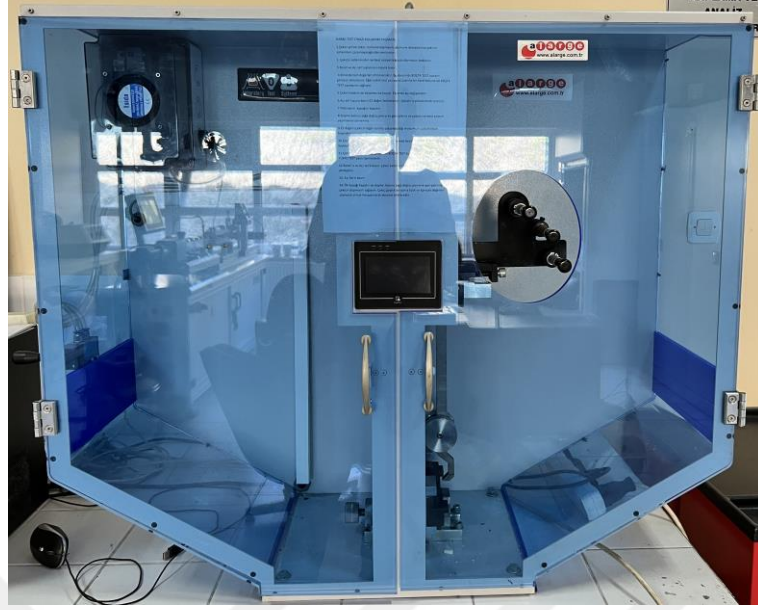
Şekil 2.23: Alarge marka izod darbe cihazı ve deney numuneleri.
