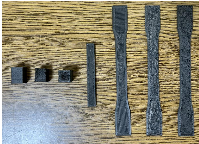
Şekil 2.9: PA66-20KE filament nemli olduğunda oluşan üretim hataları.
