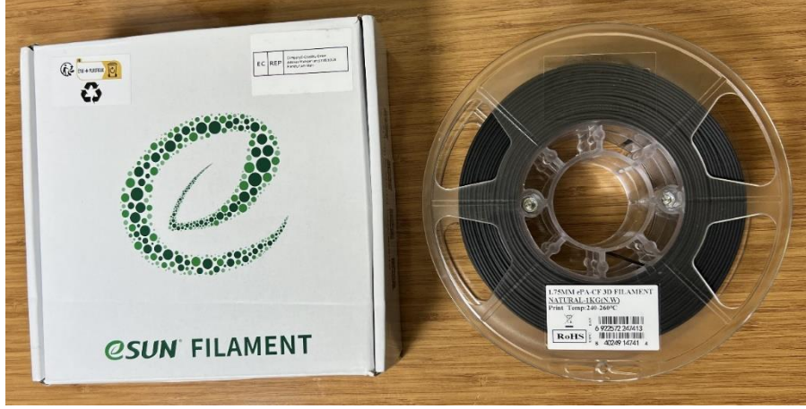
Şekil 2.1: ESUN ePA-CF ticari kodlu PA66-20KE karbon elyaf takviyeli filament.
