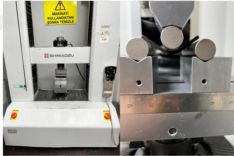
Şekil 2.20: Üç nokta eğme testinden görüntüler.
