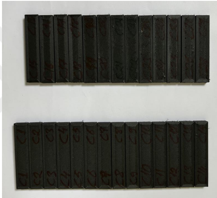
Şekil 3.23: İzod darbe deneyi numuneleri.
