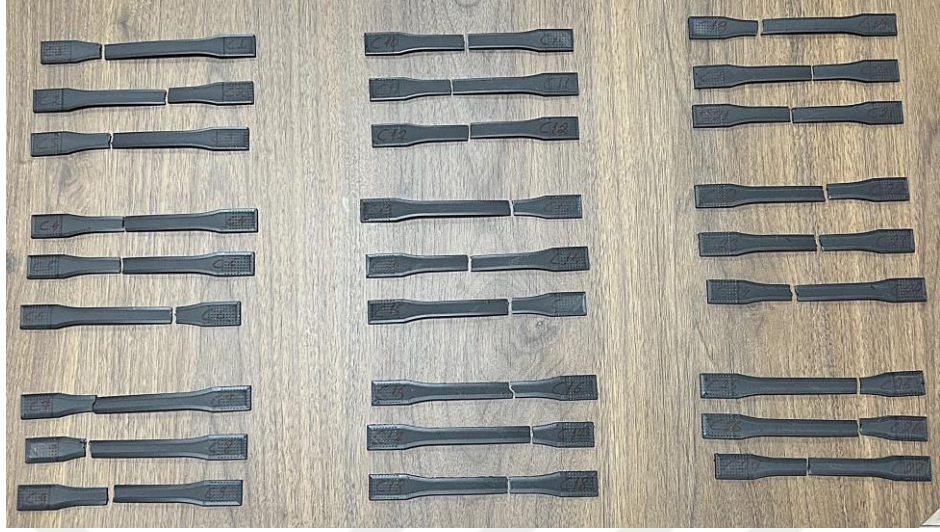
Şekil 3.5: PA66-20KE filament ile üretilen çekme test numunelerin çekme testi sonrası görselleri.
