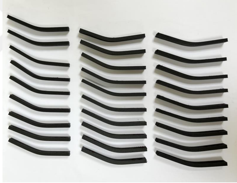
Şekil 3.18: Üç nokta eğme testi sonrası numune görselleri.
