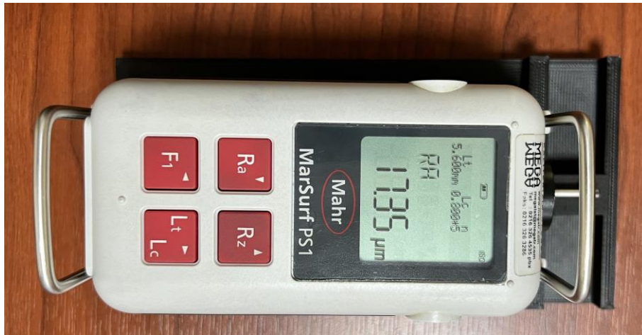
Şekil 3.29: Yüzey pürüzlülüğü ölçüm cihazı.
