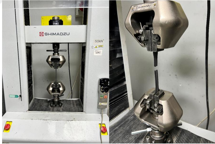
Şekil 2.13: Shimadzu 5 tonluk çekme test cihazı.
