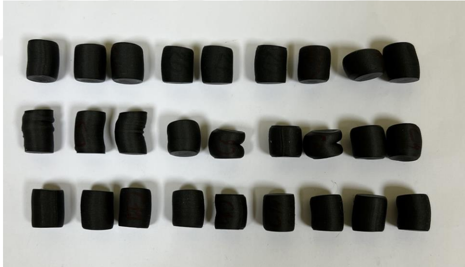
Şekil 3.12: Basma deneyleri sonrası numune görüntüleri.
