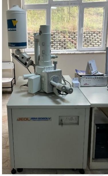
Şekil 2.24: JEOL marka model JSM- 6060LV SEM görüntü cihazı.
