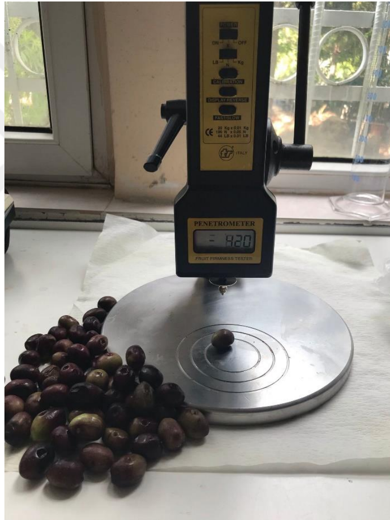
Şekil 3.14. Penetrometre ile meyve eti sertliği ölçümünden bir görünüm
