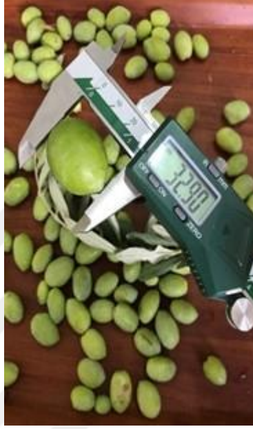
Şekil 3.11. Dijital kumpas ile meyve eni ve boyu ölçümünden bir görünüm
