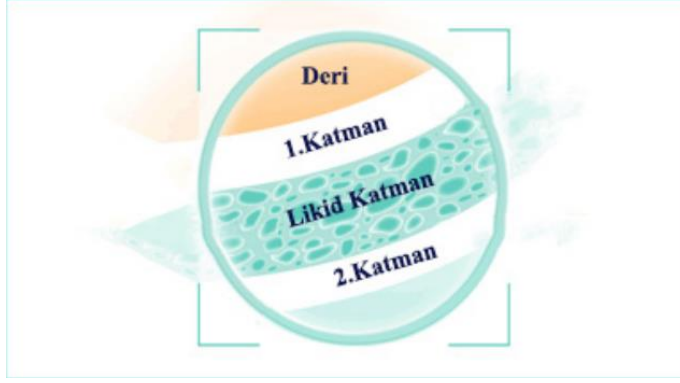
Şekil 1: Katmanlı likit dolgulu eldiven yapısı.
