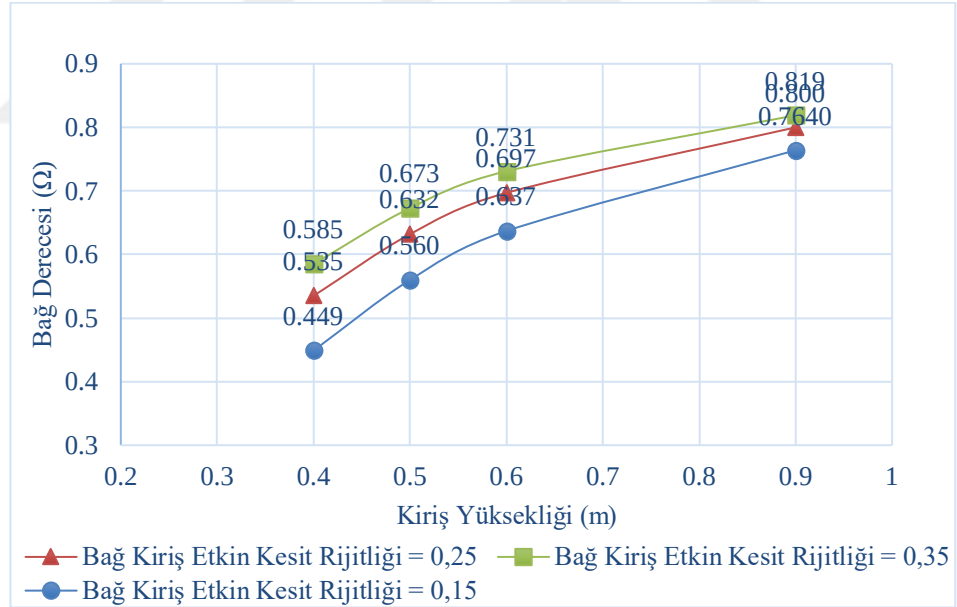
Şekil 4.22: Bağ kiriş yüksekliği – bağ derecesi katsayısı (perdenin plandaki uzunluğu a = 2m ve bağ kirişin plandaki uzunluğu l = 3m , kat adedi = 10 kat).
