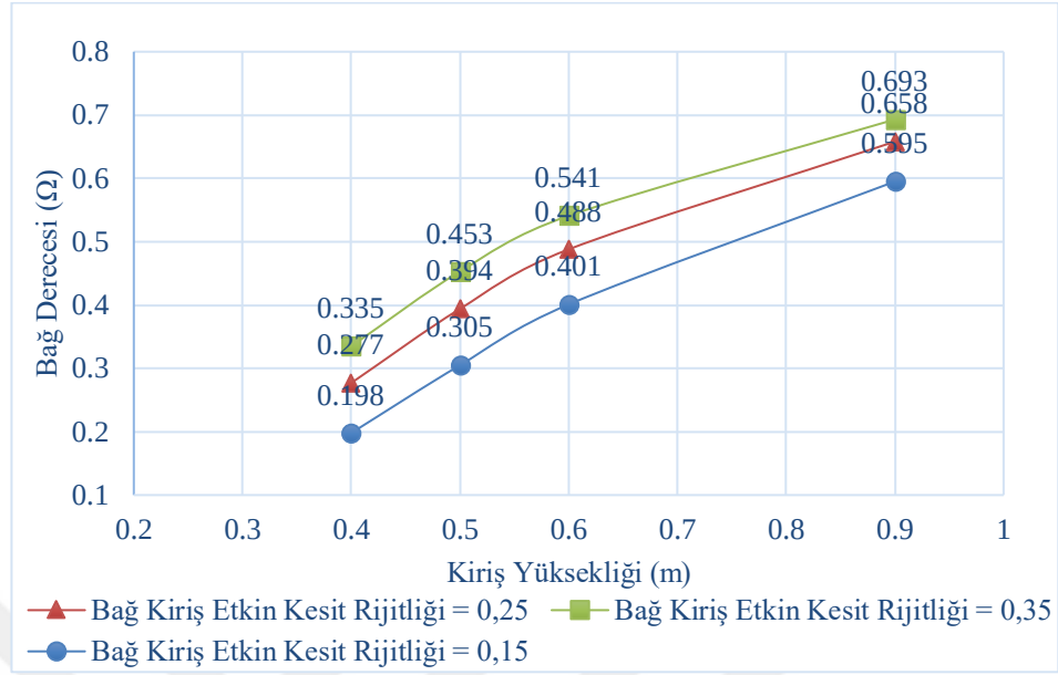
Şekil 4.23: Bağ kiriş yüksekliği – bağ derecesi katsayısı (perdenin plandaki uzunluğu a = 2 m ve bağ kirişin plandaki uzunluğu l = 4 m, kat adedi = 6 kat).
