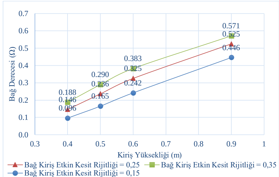
Şekil 4.14: Bağ kiriş yüksekliği – bağ derecesi katsayısı (perdenin plandaki uzunluğu a = 3\text{m} ve bağ kirişin plandaki uzunluğu l = 4\text{m} , kat adedi = 6 kat).
