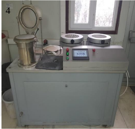
Şekil 3.2 Hamurlaştırma ve kağıt üretim işlemlerinde kullanılan Laboratuvar ekipmanları (1. Helico tip yüksek yoğunluklu pulper, 2. Hollander, 3. Dispersiyon, 4. Rapid Köthen el yapımı kağıt basma makinesi)
