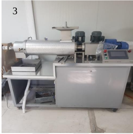
Şekil 3.2 Hamurlaştırma ve kağıt üretim işlemlerinde kullanılan Laboratuvar ekipmanları (1. Helico tip yüksek yoğunluklu pulper, 2. Hollander, 3. Dispersiyon, 4. Rapid Köthen el yapımı kağıt basma makinesi)
