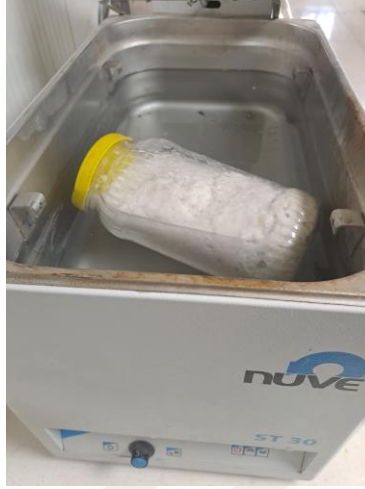
Şekil 3.4 Depolama işleminde kullanılan su banyosu
