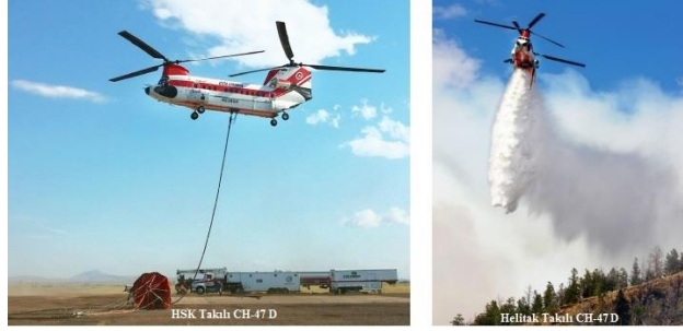
Şekil 4.15. HSK ve Helitak Monte Edilmiş CH-47D Helikopterleri
