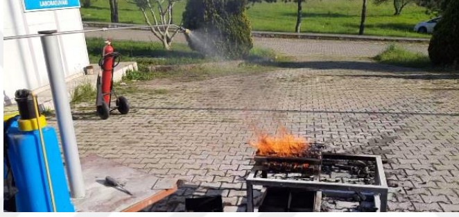
Şekil 6.41. Söndürme Mayii Yangın Üzerine Püskürtülüyor
