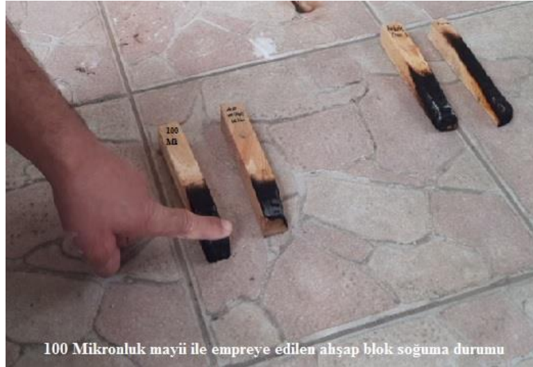
Şekil 6.69. 100 Mk Mayii İle Empreye Edilen Ahşap Bloкта Soğuma Olduđu Değerlendirildi
