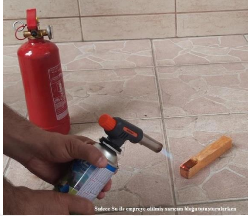
Şekil 6.57. Sadece Su İle Empreye Edilmiş Sarıçam Bloğu Tutuşturuluyor
