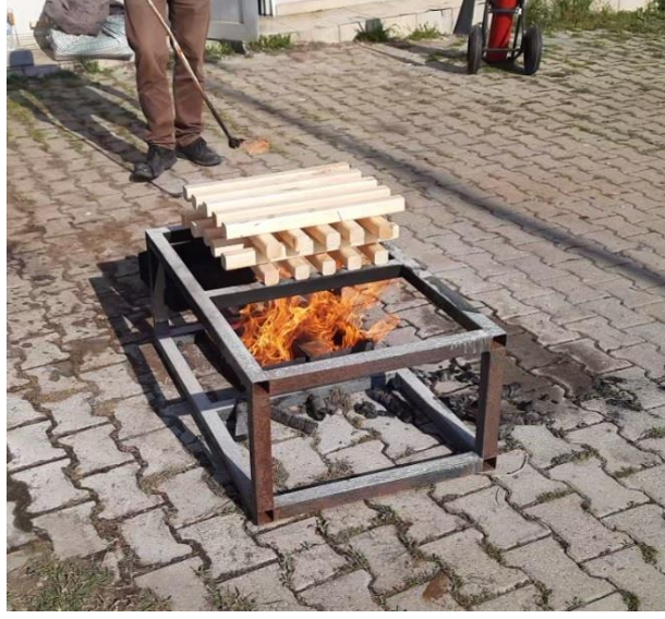
Şekil 6.29. 4x5'lik Sarıçam Blokları 1kg Benzinle Tutuşturuluyor
