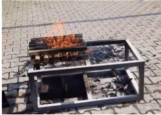
Şekil 6.39. Ahşap Bloklar Kendi Enerjisiyle Yanmaya Devam Ediyor
