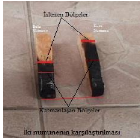
Şekil 6.61. Su İle Empreye Edilmiş Numune İle Kuru Numune İslenme ve Katmanlaşma Bakımından Karşılaştırılıyor
