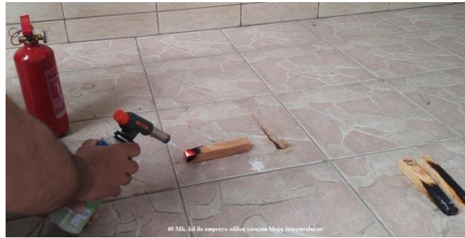
Şekil 6.63. 1lt Suyu İlave Edilen 40 Mk. 100 gr ZK kil İle Empreye Edilen Sarıçam Bloğu Tutuşurken
