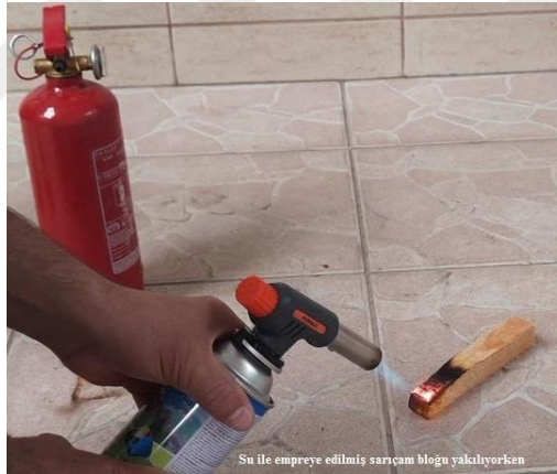
Şekil 6.58. Su İle Empreye Edilmiş Sarıçam Bloğu Yakılıyor
