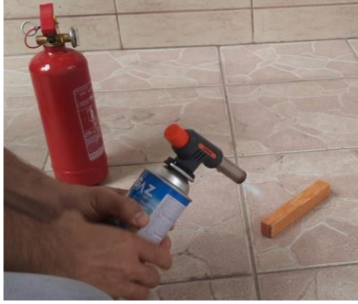
Şekil 6.50. Katkısız (Kuru) Numune Deneyi Tutuşturma Anı
