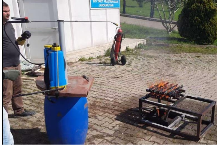
Şekil 6.21. 4x5'lik Bloklarda Yanma Devam Ederken Söndürme Süreci Başlıyor
