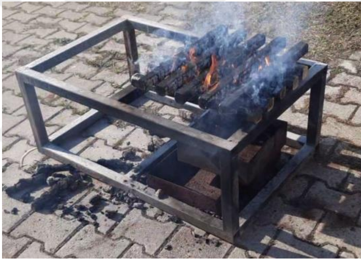
Şekil 6.28. Söndürmeyle Birlikte Duman Renginde Beyazlaşmalar Başlıyor
