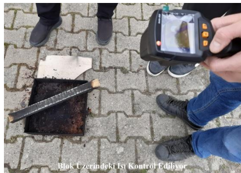
Şekil 6.7. Termal Cihaz İle Sarıçam Blok Isı Ölçümü Yapılıyor
