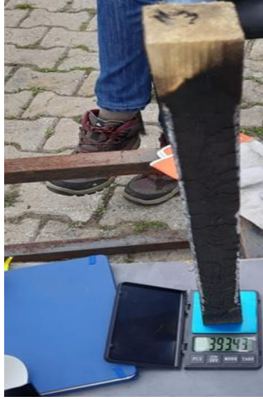
Şekil 6.11. Deney Sonrası Yanan Numune Tartılıyor
