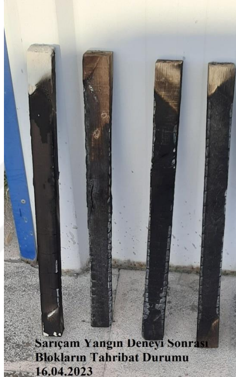
Şekil 6.14. Sarıçam Bloklarının Yanma Deneyi Sonrası Oluşan Tahribat Durumu
