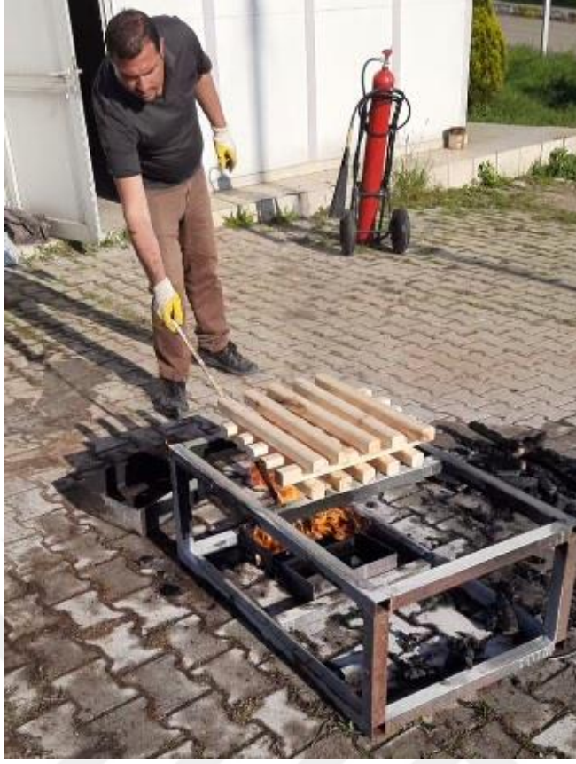
Şekil 6.35. 3x5'lik Sarıçam Bloklarını Tutuşturmak İçin 750 gr Benzin Yakılıyor
