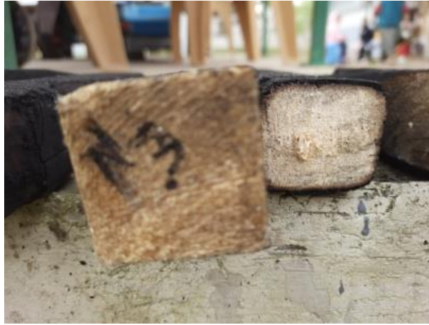
Şekil 6.16. 2.Deney Sonrası Yanan Numunenin Son Durumu
