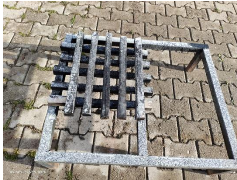
Şekil 6.13. Sarıçam Bloklarının Yanma Sonrasındaki Durumu
