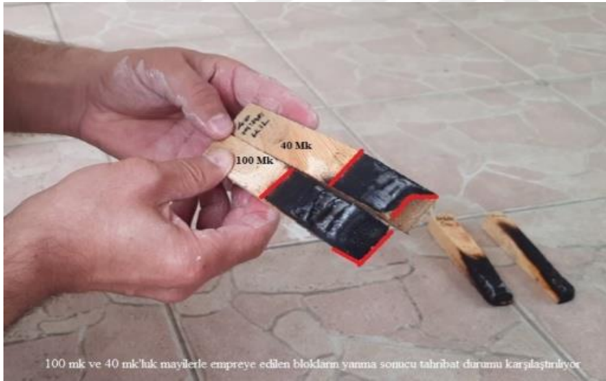
Şekil 6.71. 100 Mk ve 40 Mk'luk Mayilerle Emreye Edilen Bloklarda Yanma Sonucu Oluşan Tahribat Durumu Karşılaştırılıyor
