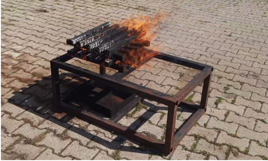
Şekil 6.23. Söndürücü Mayii Uygulanmasına Rağmen Yangın Devam Ediyor
