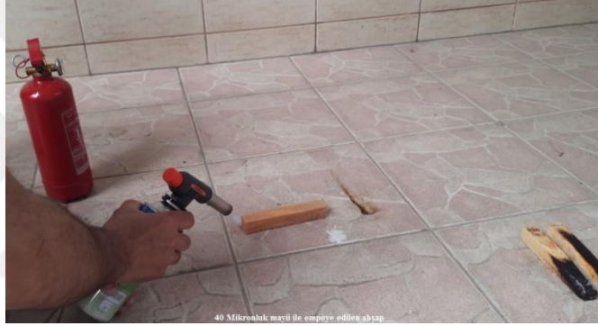
Şekil 6.62. 1lt Suyu İlave Edilen 40 Mk. 100 gr ZK kil İle Empreye Edilen Sarıçam Bloğu Tutuşturuluyor
