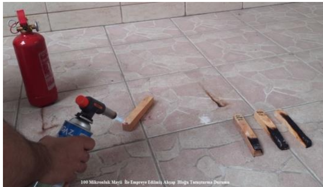
Şekil 6.66. 100 Mk. ZK Kil İle Empreye Edilmiş Ahşap Blok Tutuşturuluyor
