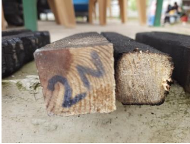
Şekil 6.15. Deney Sonrası Yanan Blok Durumu
