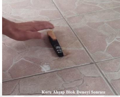
Şekil 6.54. Alev Söndükten Hemen Sonra, Isı Açığa Çıkmaya Devam Ediyor
