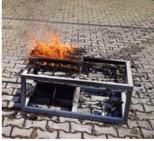
Şekil 6.46. Ahşap Bloklar Kendi Enerjisiyle Yanmaya Devam Ediyor.
