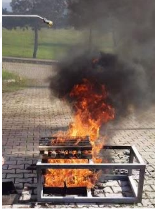
Şekil 6.38. Tavadaki Benzininde Tesiriyle Yoğun Bir Alev Gözlemleniyor
