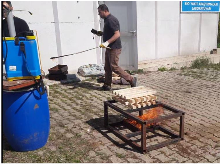
Şekil 6.19. 4x5'lik Blokları, 1 kg Benzinle Tutuşturuluyor
