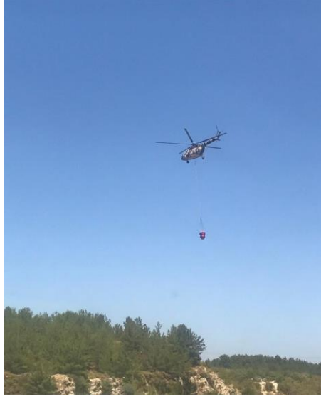
Şekil 4.17. Mi-17 HSK İle Yangın Söndürme Faaliyeti Yapıyor
