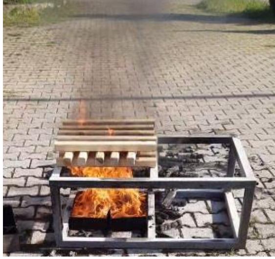
Şekil 6.37. Bloklar Alttan Tutuşmaya Başlıyor, Akabinde Siyah Duman Çıkışı Görülüyor
