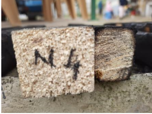
Şekil 6.17. 3.Deneyde Yakılan Numunenin Son Hali
