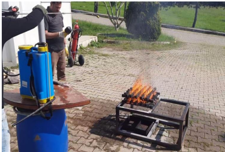
Şekil 6.20. 4x5'lik Bloklarda Yanma Süreci Devam Ediyor
