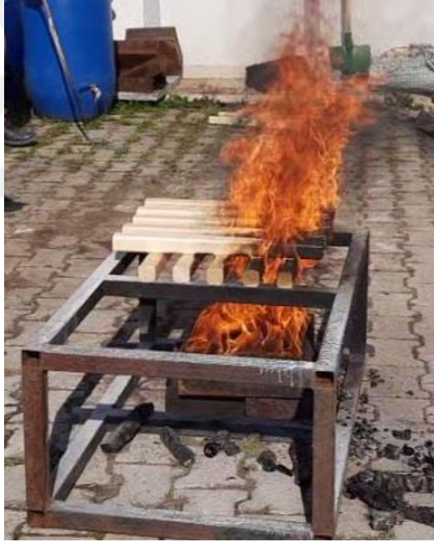
Şekil 6.26. Tutuşturulan Bloklarda, Rüzgarın Tesiriyle Alevlenme Artmıştır
