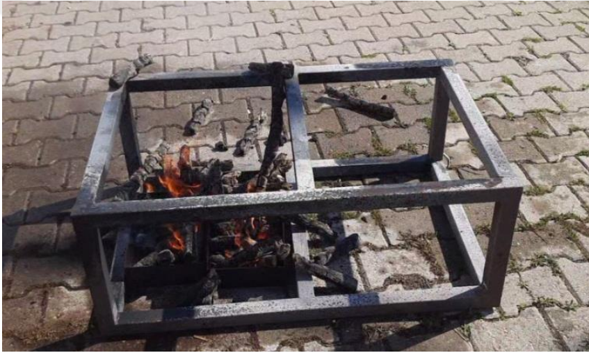
Şekil 6.24. Söndürme Yapılamamış, Bloklar Dağılmış, Yangın Devam Etmıştır
