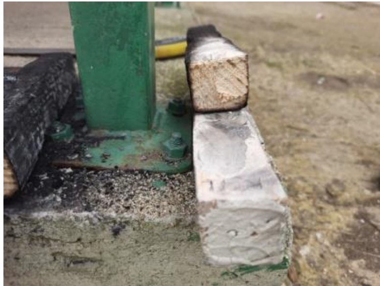
Şekil 6.18. %100 ZK Kil Uygulanarak Yakılan Bloğun Son Hali
