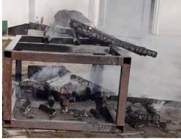
Şekil 6.34. Söndürme Akabinde Bloklar Dağılıyor, Beyaz Duman Görülüyor
