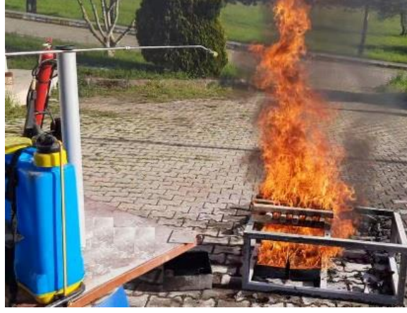
Şekil 6.45. Tavadaki Benzinin Etkisiye Bloklar Üzerindeki Alev Miktarı Oldukça Yükseliyor
