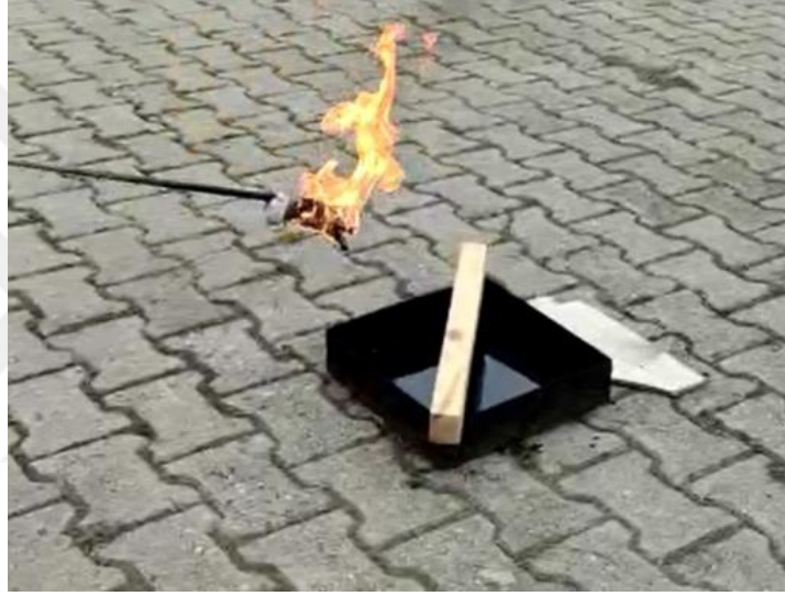
Şekil 6.9. Tava Tutuşturularak Blok Yakılıyor
