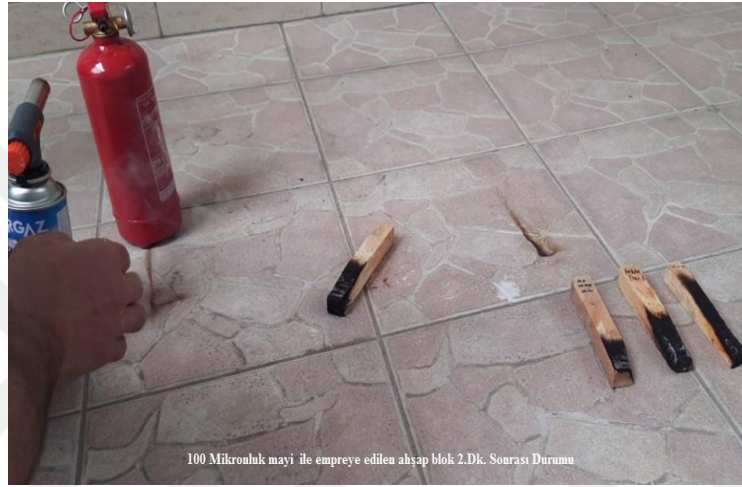
Şekil 6.68. Ahşap Bloğun 2dk. Sonraki Durumu
