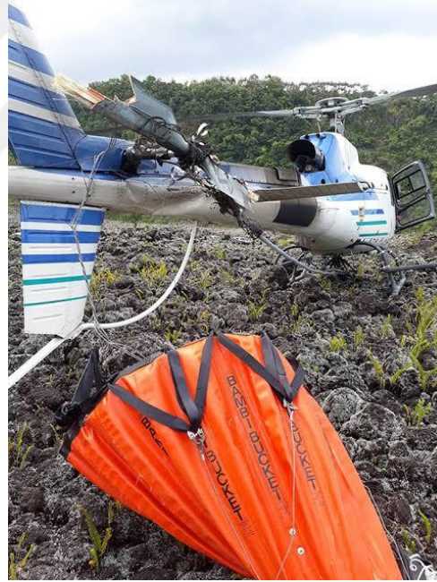
Şekil 4.35. Kuyruk Rotoru Dolanan HSK ve Kaza Kırım Yapan Bir Helikopter
