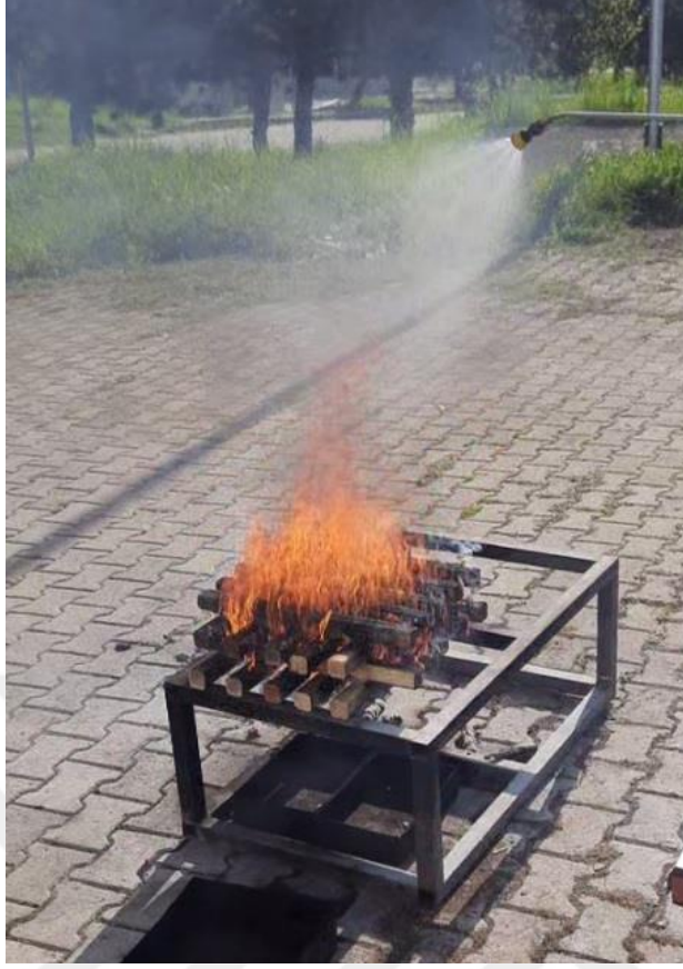
Şekil 6.32. Söndürme Esnasında Su Sisi ve Beyaz Duman Görülüyor
