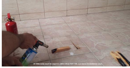
Şekil 6.64. 2dk. Isıya Maruz Kalan Sarıçam Bloğunda Alev Görülmedi
