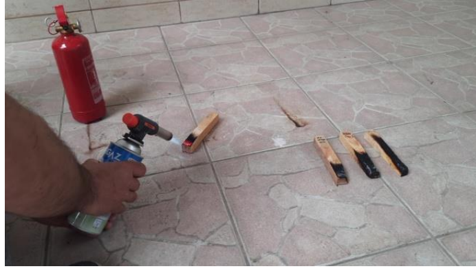
Şekil 6.67. Isıya Maruz Bırakılan Ahşap Bloğun Tutuşma Durumu
