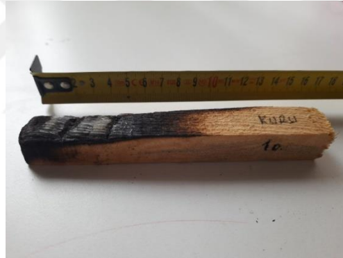
Şekil 6.55. Kuru Odun Deneyi Tahribat Durumu
