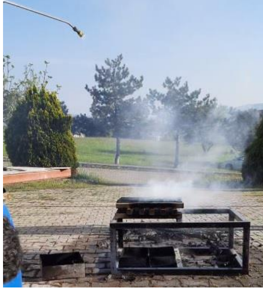
Şekil 6.48. Söndürme Yapılmış, Sıcak Kalan Bloklarda Tütme Devam Ediyor
