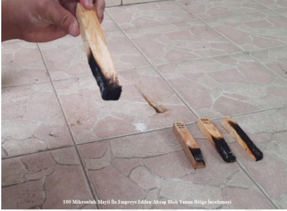
Şekil 6.70. 3dk Bekleme Esnasında Kontrol Edilen Ahşap Bloкта İslenme ve Katmanlaşma Görüldü
