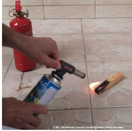
Şekil 6.59. Sarıçam Bloğu 2 dk. Yakıldıktan Sonra Kendiliğinden Yanıyor
