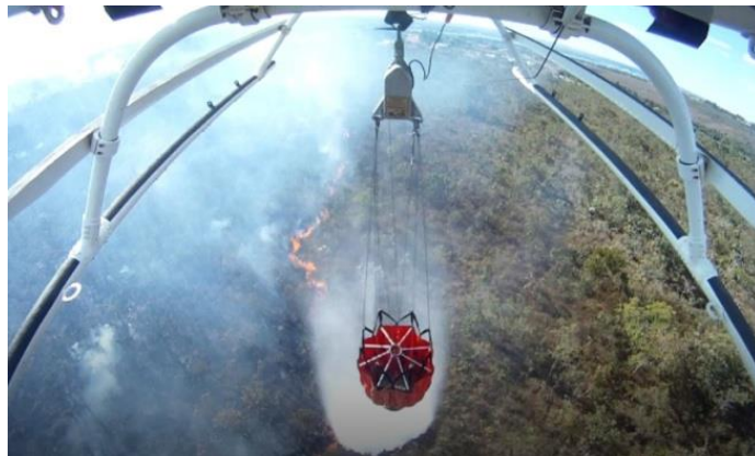
Şekil 4.26. Bambi Bucket İle Yangın Söndürme Anı
