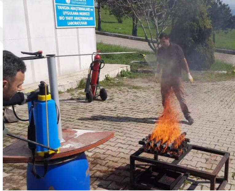
Şekil 6.22. Söndürme Sürecinde Yer-Yön Değiştiren Rüzgarın Etkisiyle Alev Yüksekliği Farklı Seyredebiliyor
