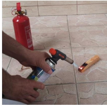
Şekil 6.52. Kuru Numune Yakılıyor
