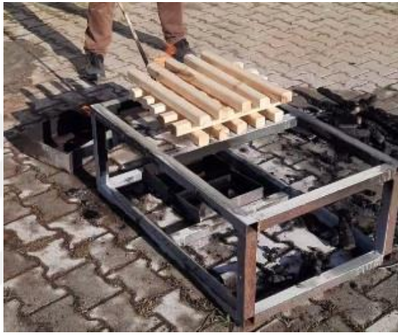
Şekil 6.43. 3x5'lik Sarıçam Blokları ve Deney Düzeneği Hazırlanmıştır
