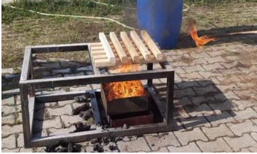
Şekil 6.25. 2x5'lik Sarıçam Blokları 500 gr Benzinle Tutuşturulmuş ve Yanma Başlamıştır
