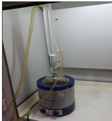
Şekil 45. rGO sentezi için yapılan reflux işlemi görüntüsü
