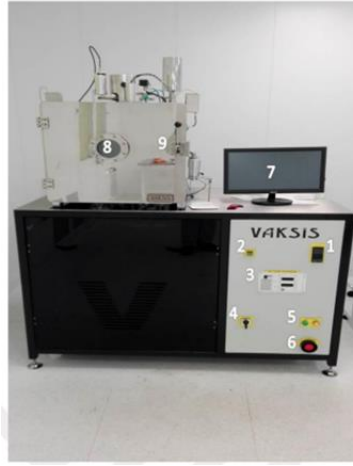
Şekil 47. Manyetik saçırma sistemi. (1) Altlık ısıtıcı PID kontrolcüsü (2) Bilgisayar açma/kapama butonu (3) DC güç kaynağı (4) Ana şalter (5) Başlatma durdurma butonları (6) Acil durdurma butonu (7) Kontrol ünitesinin monitörü (8) Plazma kontrol penceresi (9) (Yıldız 2023)
