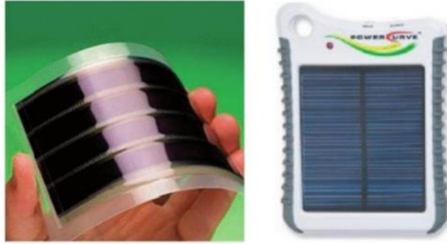
Şekil 8. G24 boyaya duyarlı modül (solda) ve güç eğrisi şarj cihazı (sağda) (Sekaran and Marimuthu 2024)
