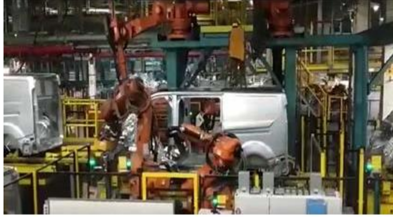
Şekil 1.3. Kaynak İstasyonu – Ford Otosan Gölcük Fabrikası (Deniz ve Çakır, 2020)
