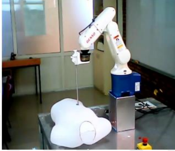
Şekil 1.7. 6 Eksen Robot Kolun Cerrahi Uygulamalarda Kullanımı (Almusawi ve ark., 2016).
