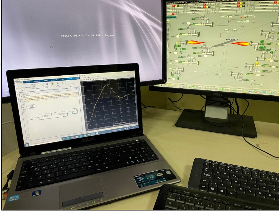
Şekil 6.1 : Matlab Simulink notebook ve PLC haberleşme testleri.
