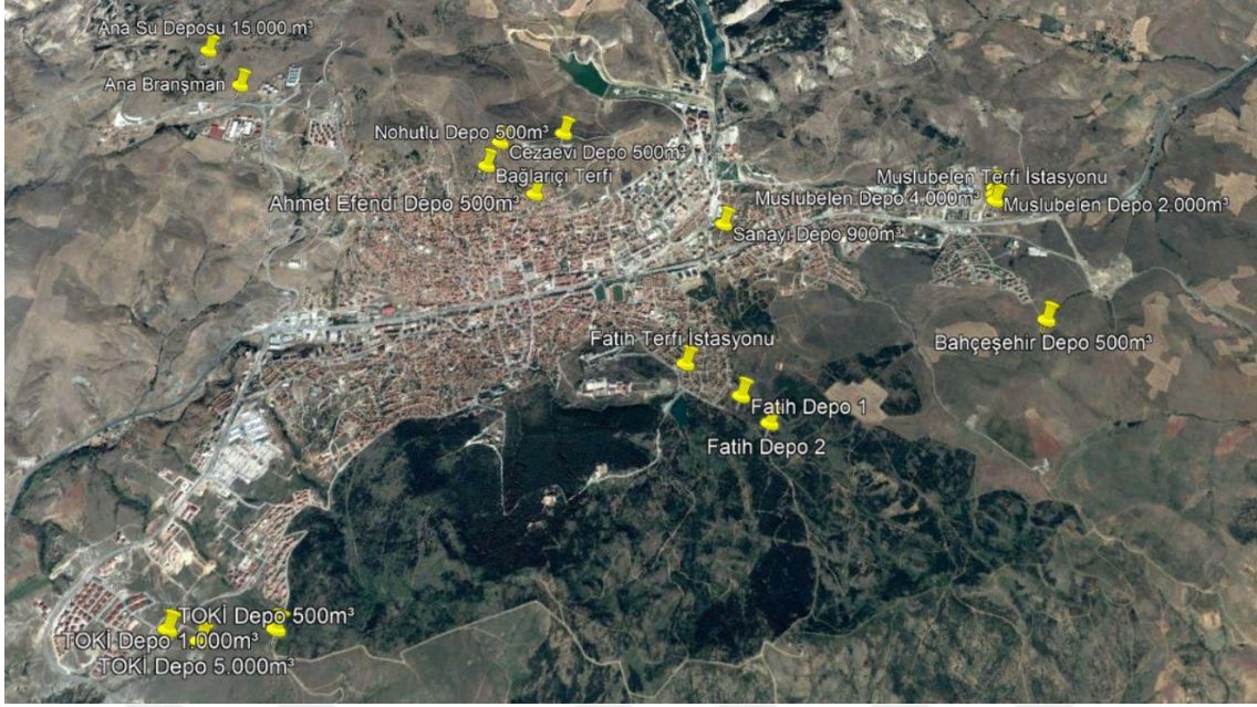
Şekil 4.2. Yozgat merkez su depolama tankları planı
