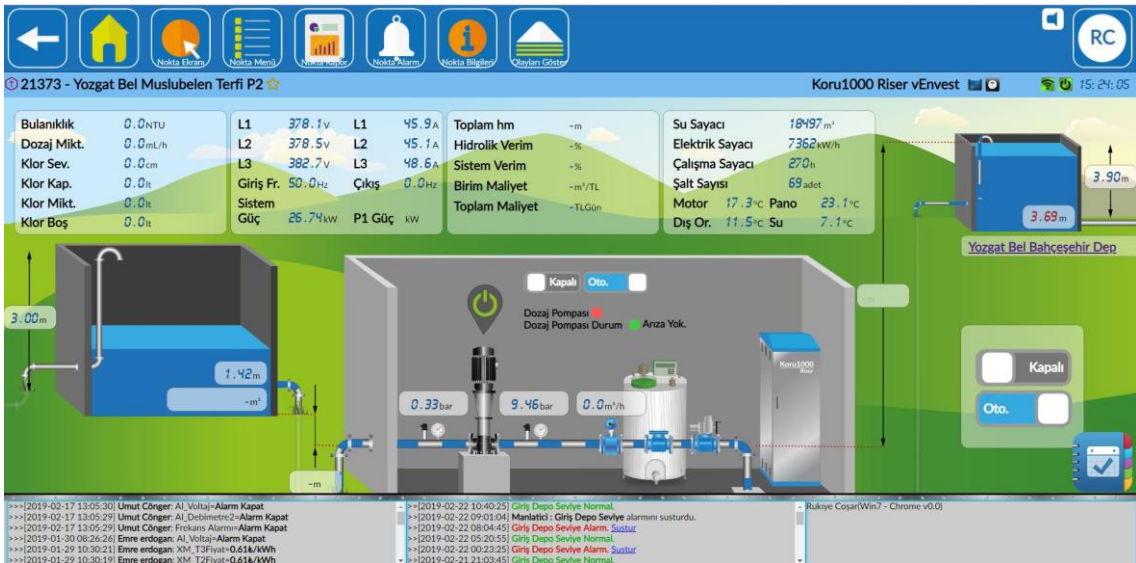
Şekil 4.16. Muslubelen terfi merkezi 2 numaralı pompa
