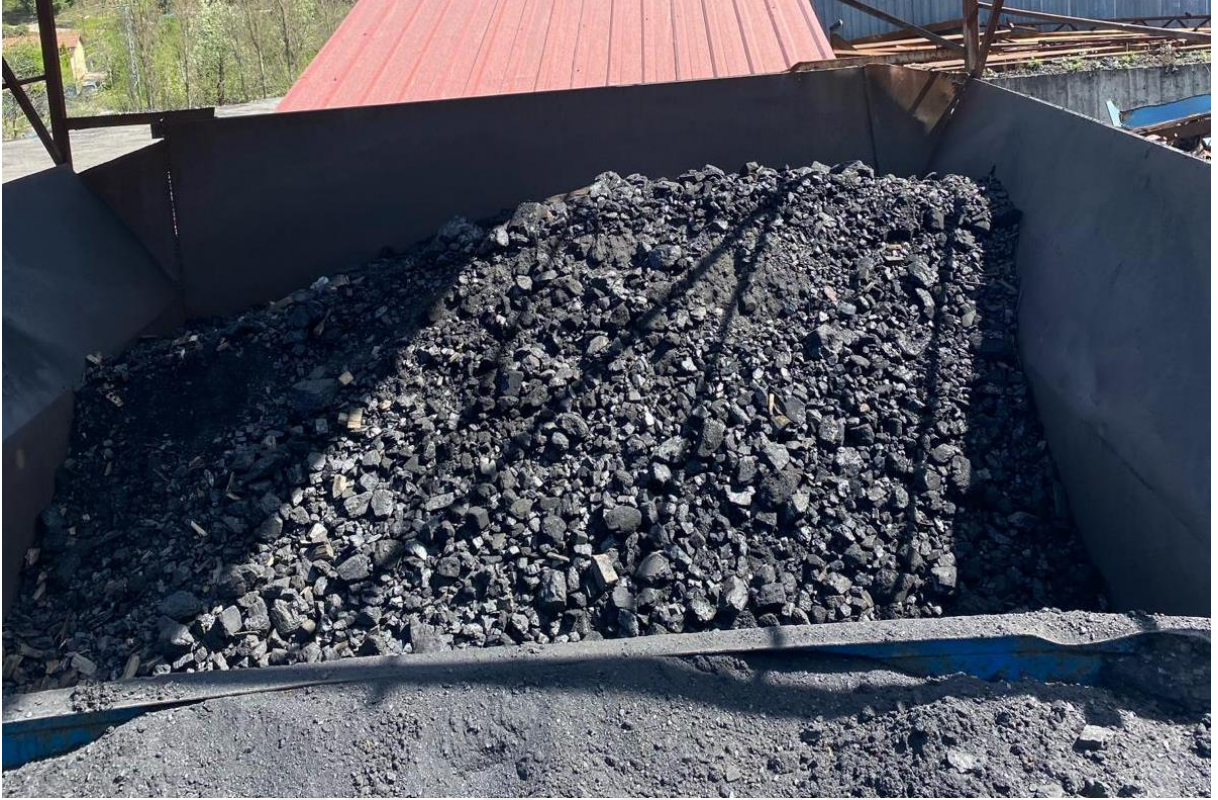
Şekil 7.5 Taşıma araçlarına kömür yükleme bunkerı.
