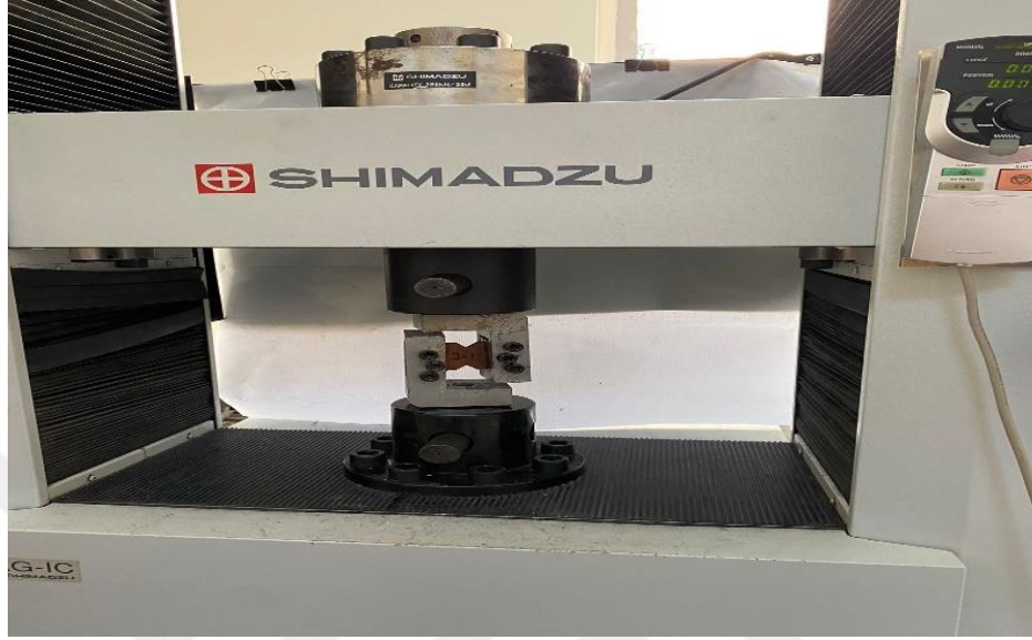
Görsel 3.9. Kayma test cihazına yerleştirilen numune kesitinden bir görünüm
