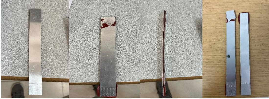
Görsel 4.1. AL1050-Karbon Fiber-EPDM-CuCrZr numunelerinde oluşan hasarın ön, arka ve yandan görünümü
