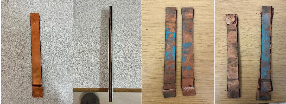
Görsel 4.2. CuCrZr-Karbon Fiber-EPDM-AL 1050 numunelerinde oluşan hasarın ön, arka ve yandan görünümü
