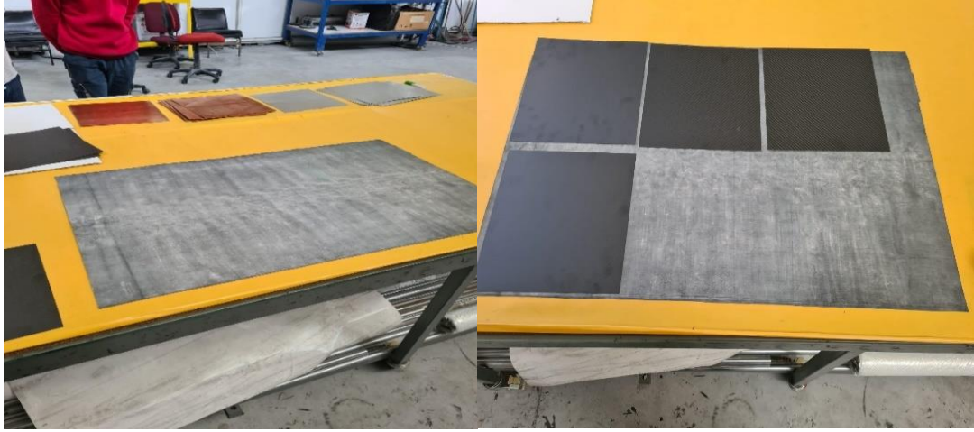
Görsel 3.3. Malzemelerin kesilmesi ve yüzeyin hazır hale getirilmesi
