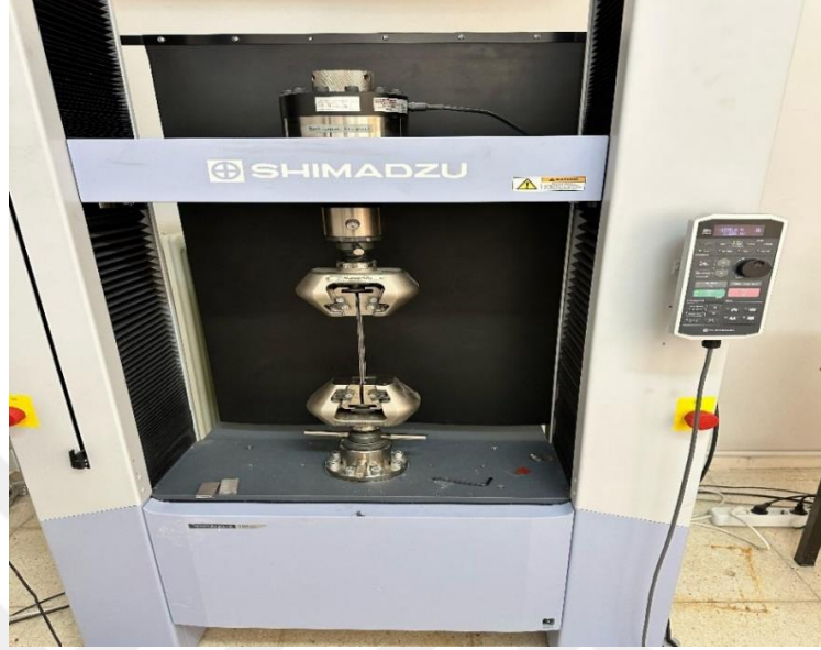
Görsel 3.7. Shimadzu mekanik çekme deney cihazına yerleştirilen numuneden bir görünüm
