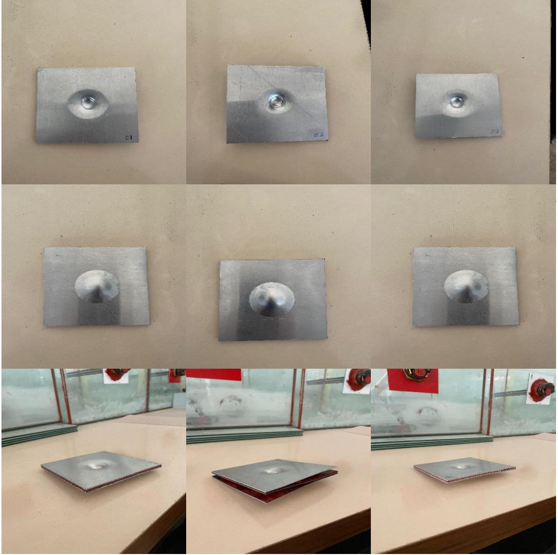
Görsel 4.5. Darbe testi sonucunda AL-1050-H18-Karbon Fiber-EPDM-CuCrZr numunelerinde oluşan hasarın ön, arka ve yan yüzeyinden görünümü
