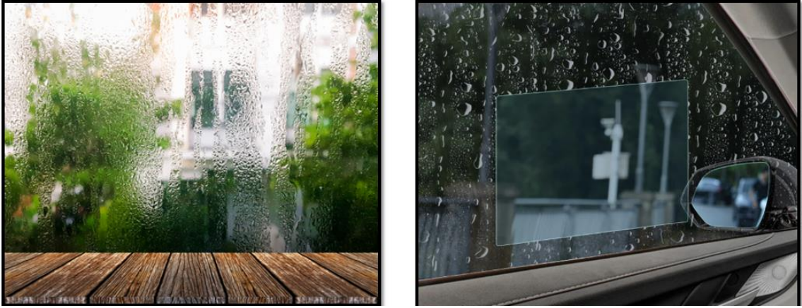
Şekil.2.5. Nano teknolojik cam (Applications of Nanotechnology-Based Self-Cleaning Resimde de görüldüğü üzere camlarda nanomalzeme kullanımının buğu önleme, kendi kendini temizleme ve suyu kaydırma gibi özellikleri bulunmaktadır.
