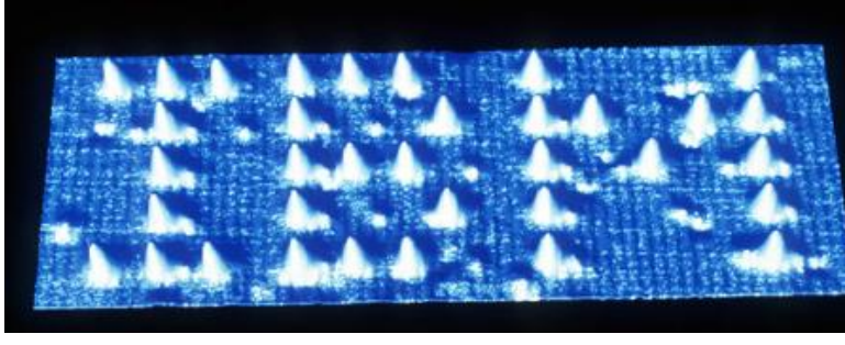
Şekil 2.2. 35 xenon atomuyla kaplanmış nikel bir yüzey üzerinde IBM logosu (Sinc, 2024)
