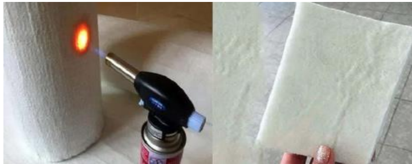
Şekil 2.6. Resimde de görüldüğü üzere termal yalıtım aerogel etkili nanomalzemeler ısıyı yalıtımda ve yangın gibi riskleri önleyebilmektedir.(Endüstriyel Sıcak Isı Yalıtımı İçin Keçe 3mm Aerogel Yalıtım Levhası, 2024)
