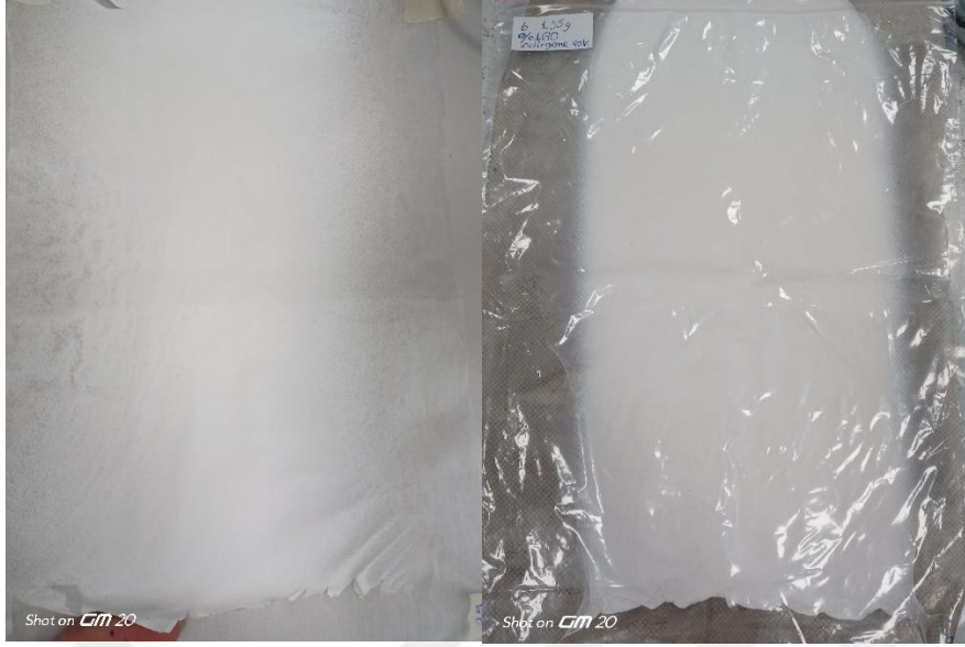
Şekil 2.15. Elektro Çekim ile Dokunmamış Kumaş Üzerinde Elde Edilmiş Nanolifli Yapı Numuneleri
