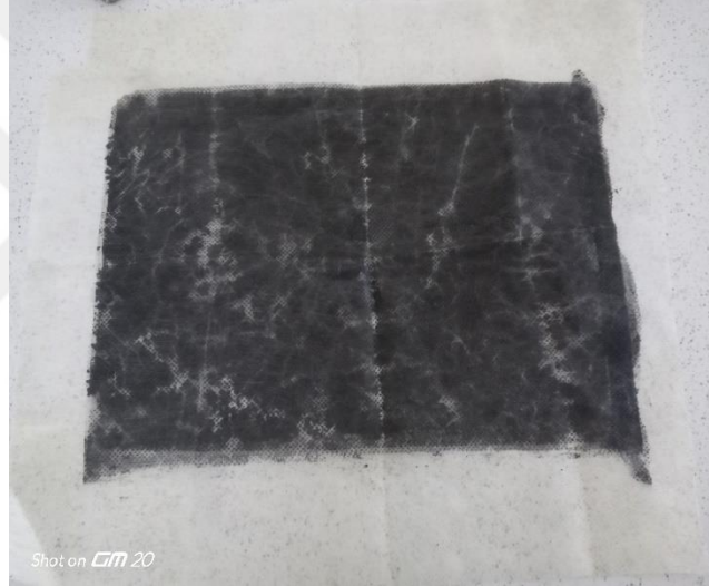
Şekil 2.14. Elektro Çekim Öncesi İndirgenmiş GO Rakle Kaplı Dokunmamış Kumaş
