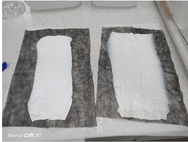
Şekil 2.22. Emdirme Yöntemi Uygulanmış Kumaş Elektro Çekim Sonrası İndirgenmiş Halde Kurutma Aşaması
