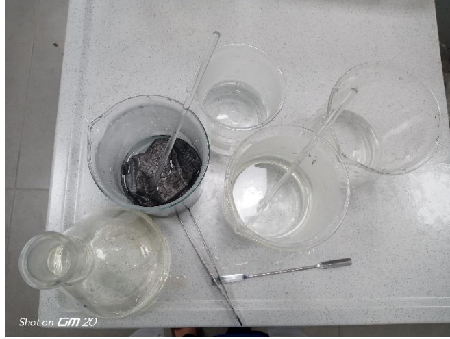
Şekil 2.13. Kaplanmış Kumaşın İndirgeme İşlemi Sonrası Kademeli Yıkama Aşaması
