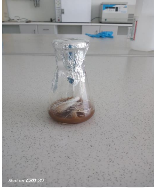
Şekil 2.16. İplik Formundaki PVDF ile GO Katkılı Polimer Çözeltisinin Hazırlanması
