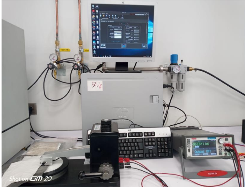
Şekil 2.28. Keithley 2450 4 Nokta Uç Elektriksel Direnç Ölçüm Cihazı
