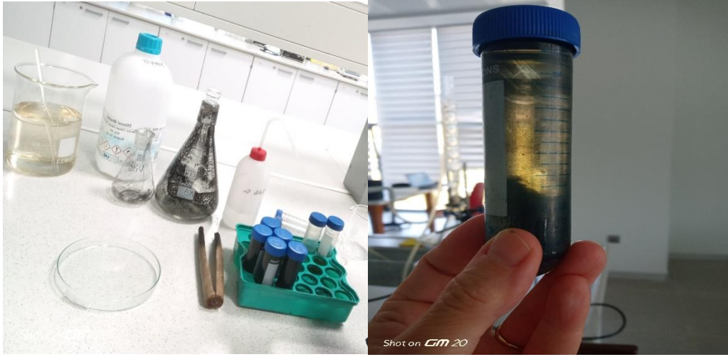
Şekil 2.18. Santrifüj Hazırlık İşlemi ve pH Kontrolü (solda), Çöken Partikül Kontrolü (sağda)
