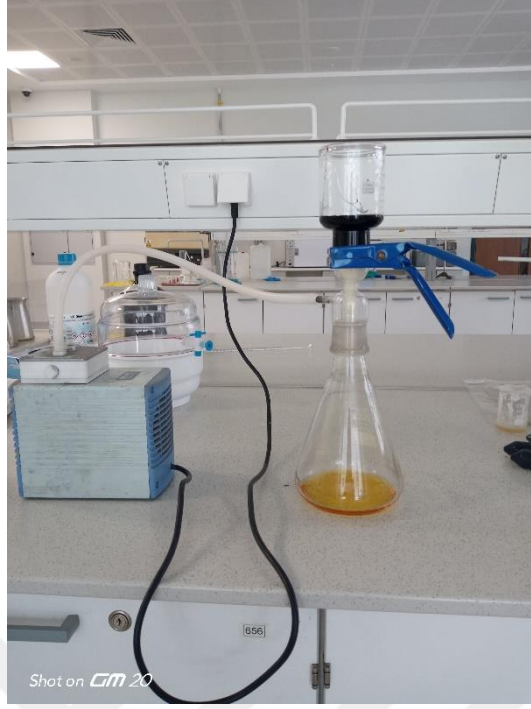
Şekil 2.17. Filtrasyon ile Yıkama İşlemi
