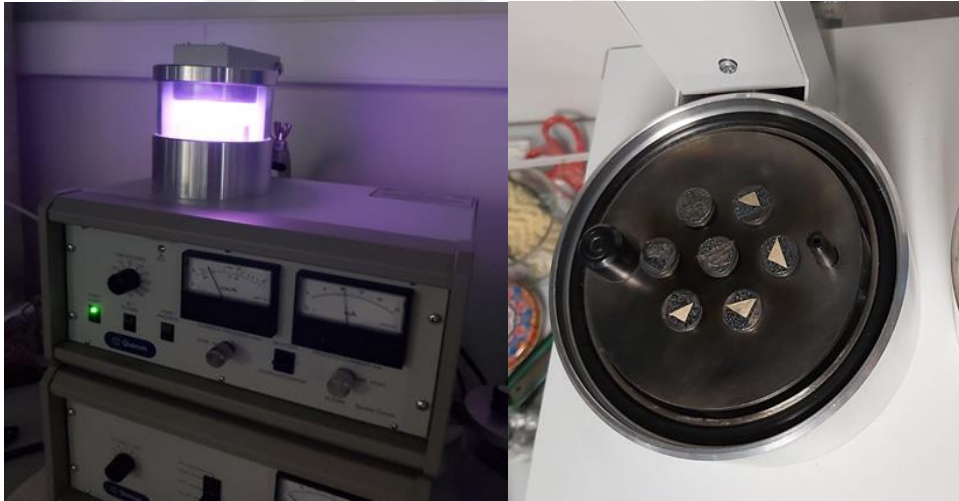
Şekil 2.24. Kaplama Cihazı ve İşlemi (solda), Au/Pd Kaplanan Numuneler (sağda)
