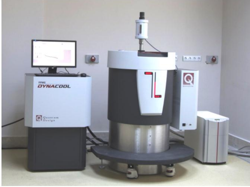
Şekil 3.9. Fiziksel Özellikleri Ölçüm Sistemi (PPMS)
