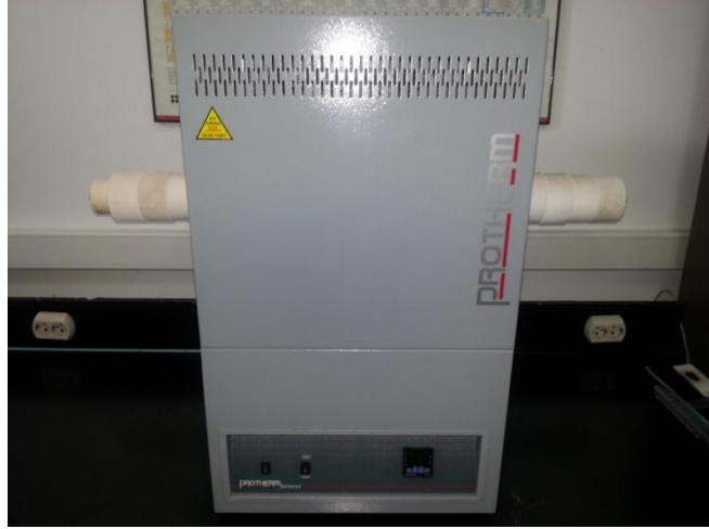
Şekil 3.3. Protherm marka, 1700 °C'ye kadar çıkabilen silindir fırın
