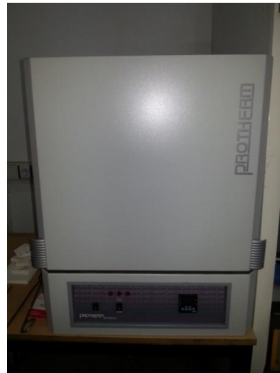
Şekil 3.2. Protherm marka, 1400 °C'ye kadar çıkabilen kül fırın
