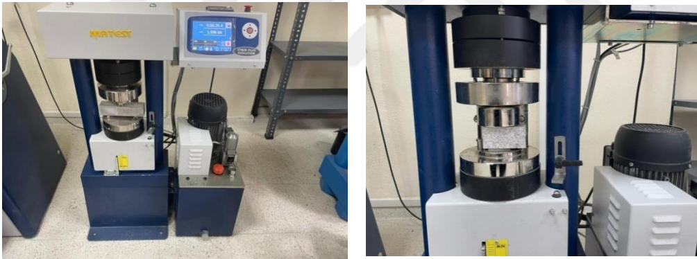
Şekil 3.4. Universal test cihazı; a) eğilme b) basınç
