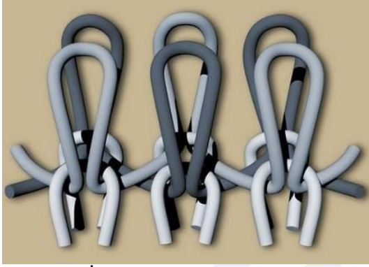
Şekil 2.2: İnterlok kumaşın yapısı (URL_35)
