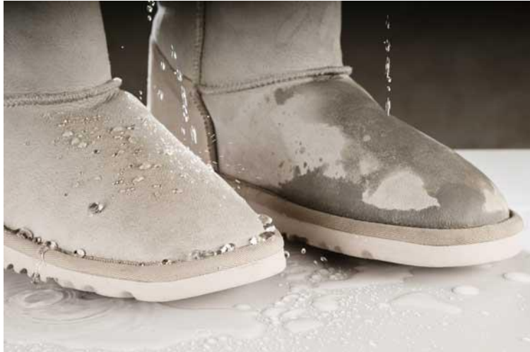
Őekil 1.17. Çizmeye Yapılan Su Geęirmezlik Özellik Kazandıran Nanoboyuttaki İřlem
