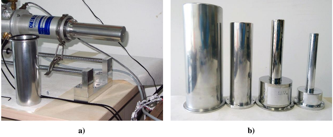
Şekil 2.15. Kriyostat, radyasyon kalkanı ve dış ceket a) Radyasyon kalkanı genel görünümü, b) Sol tarafta yeni yaptırılan radyasyon kalkanı ve dış ceket
