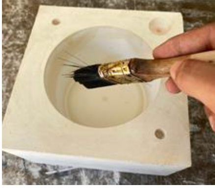
(Model kalıba gomalak sürülmesi)
