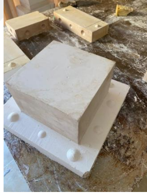
(Teksir kalıp yapım aşaması)
