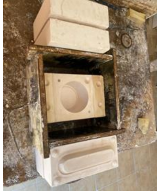
(Teksir kalıp yan gömlek dökümü)
