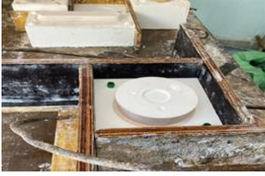
(Model, model kalıbı dökümü ve takozu) (Döküm ağız parçası için hazırlık)
