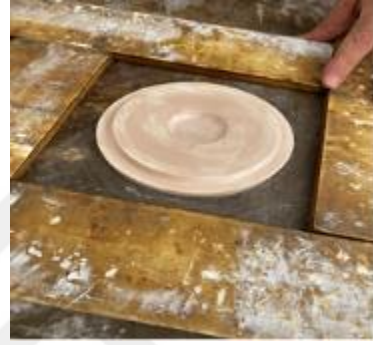
(Model yatağı ve dökümü için kenar kurulumu)
