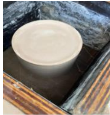
(Model, model kalıbı dökümü için çerçeve)
