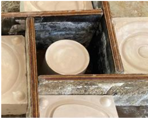
(Model, model kalıbı dökümü için çerçeve)
