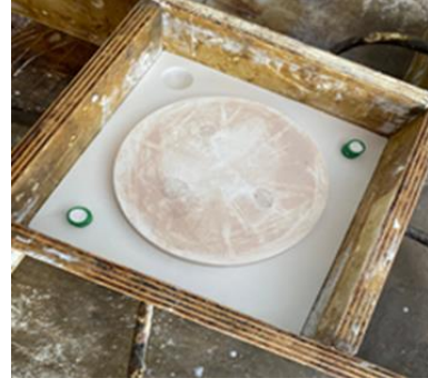
(Model, model kalıbı dökümü ve takozu) (Döküm ağız parçası için hazırlık)
