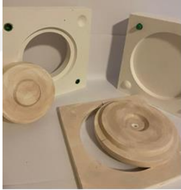
(Model kalıbı, takozu, model yatağı ve model)
