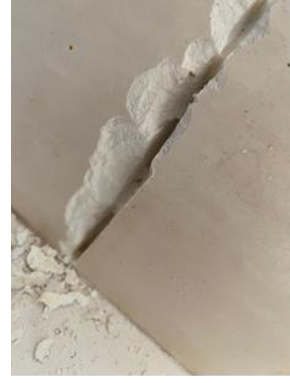
(Teksir kalıptan model kalıbının ayrılması)
