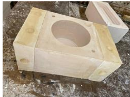
(Teksir kalıp yan gömlek dökümü)
