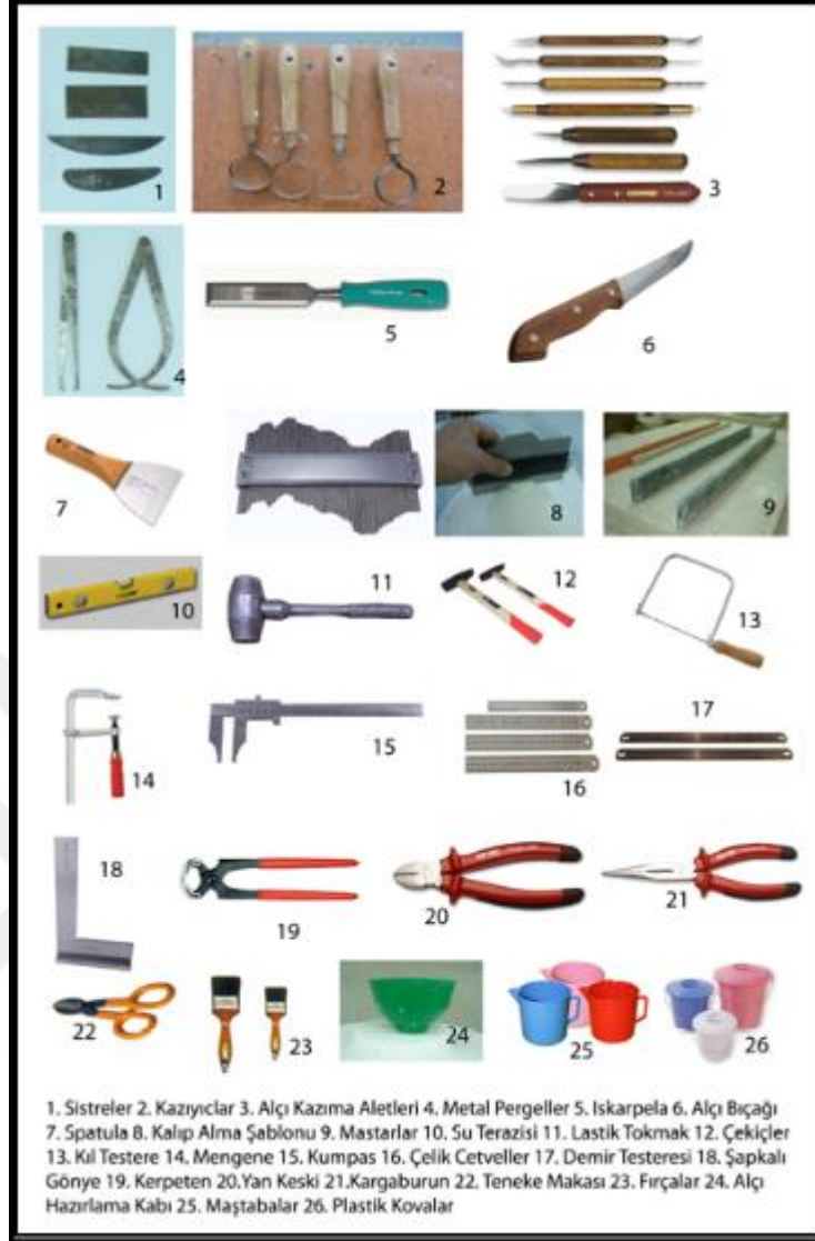
Resim 4.5 Model yapılırken kullanılan alet ve edevatlar (Çakar, 2008: 21)
