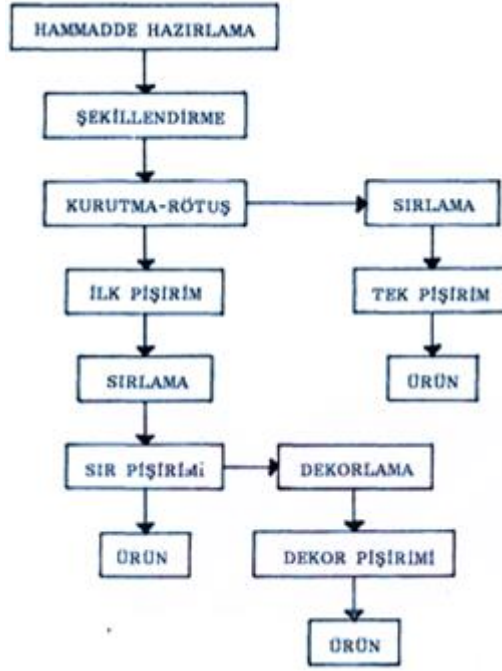
Resim 3.1 Endüstriyel seramiğin üretim şeması (Kura, 1989: 2)
