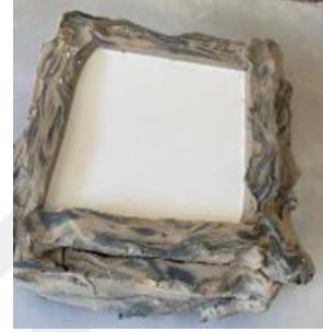
(Şablon çekilmek üzere dökülen alçı)
