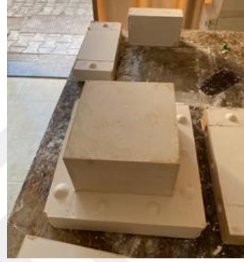
(Teksir kalıp yapım aşaması)
