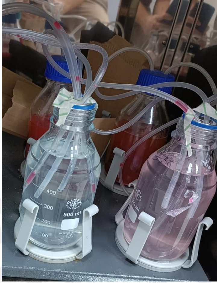
Şekil 2.2. Gilaburu meyvesinden şarap üretimi fermantasyon düzeneği
