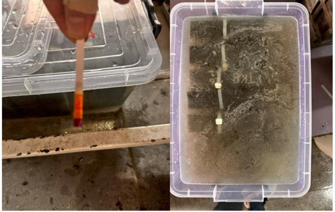
Şekil 40. pH Ölçümü ve Numunelerin Seyreltilmiş HCl Asit içine Alınması
