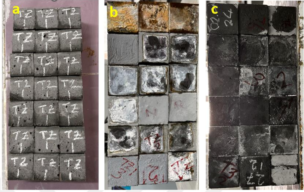
Şekil 38. (a) Su, (b) HCl Asit ve (c) NaClO Baz, Ortamlarına Maruz Bırakılan Küp Numuneler
