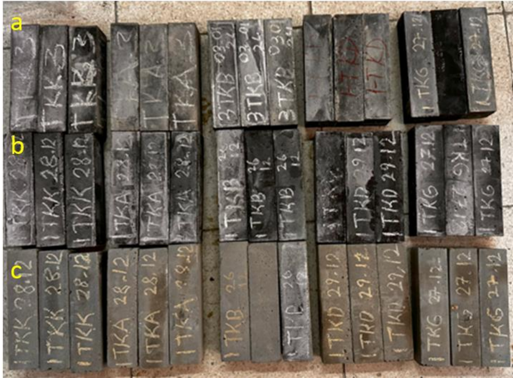
Şekil 39. (a) Su, (b) NaClO Baz ve (c) HCl Asit Ortamlarına Maruz Bırakılan Prizma Numuneler
