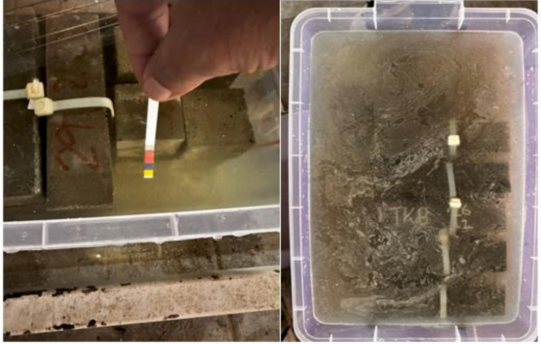
Şekil 41. pH Ölçümü ve Numunelerin Seyreltilmiş \text{NaClO} Baz İçine Alınması
