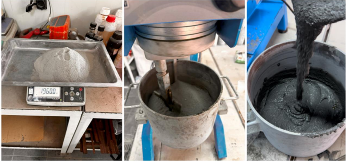
Şekil 27. Harç Üretim Çalışmaları
