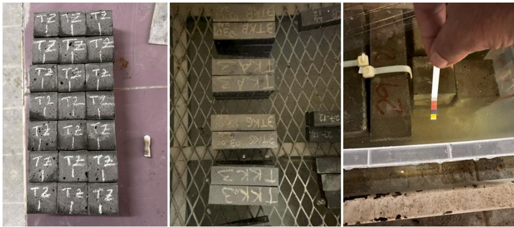
Şekil 29. Numunelerin Su, HCl Asit ve NaClO Baz Kaplarına Alınması
