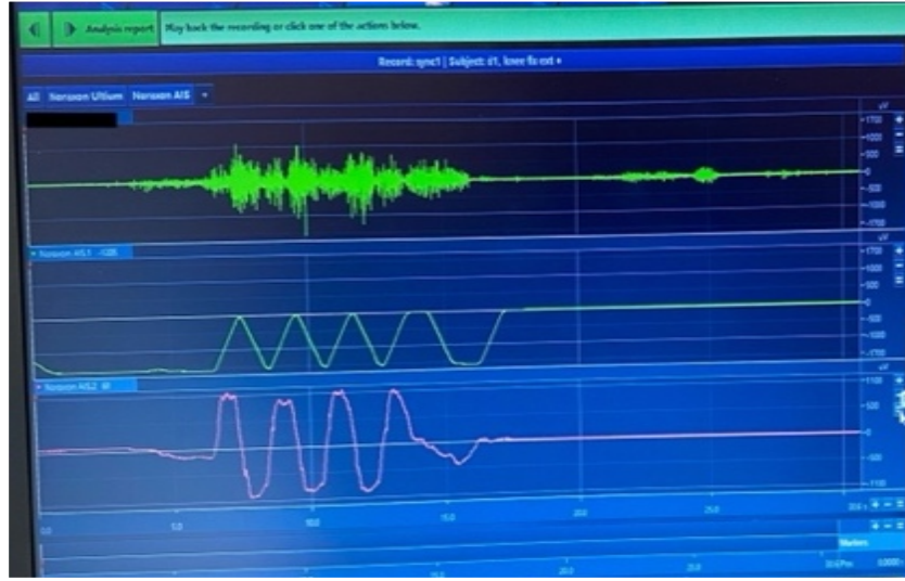
Şekil 3.3. İzokinetik dinamometre ve yEMG cihazının senkronizasyonu.
