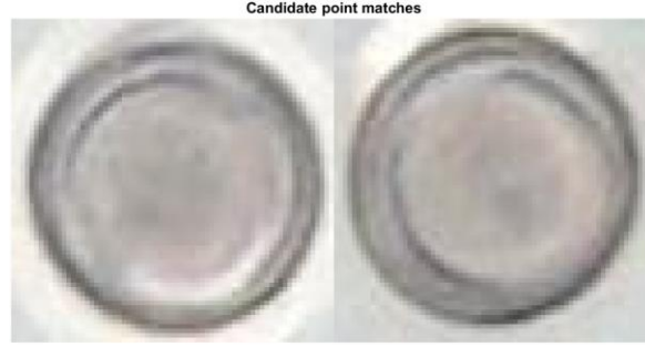
Şekil 3.36. SURF yönteminin uygulanması sonucunda tanımlayıcı ve eşleşme elde edilememesi
