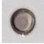
Şekil 3.37. Uygun punta kaynağı örnek görüntüsü
