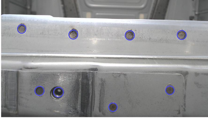
Şekil 3.16. Ana görüntü üzerinde tespit edilen punta kaynaklar
