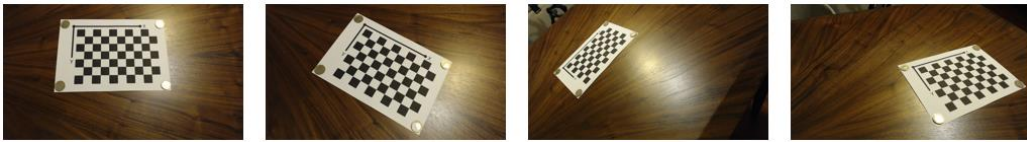
Şekil 3.1. Kamera kalibrasyonu için dama tahtası görüntü örnekleri
