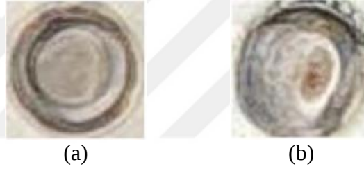
Şekil 3.51. (a) "uygun" sınıfına, (b) "uygun olmayan" sınıfına ait punta kaynak görüntüleri
