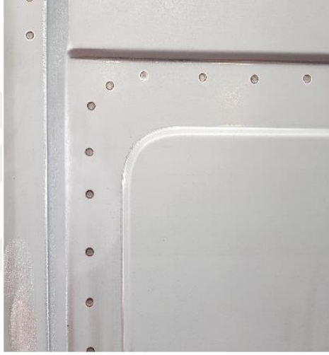
Şekil 3.6. Karoseri yüzeyi görüntüsü ve punta kaynaklar
