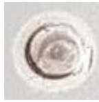
Şekil 3.38. Uygun olmayan punta kaynağı örnek görüntüsü
