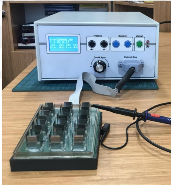
Şekil 3.8. Elektro-kültür plaka ve alternatif elektrik alan maruziyet sistemi bağlantısı
