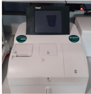
Şekil 2.47. Toplam Fenolik Madde İçeriğini Ölçen Spektrofotometre Cihazı (REL BIOCHEM-REL ASSAY)
