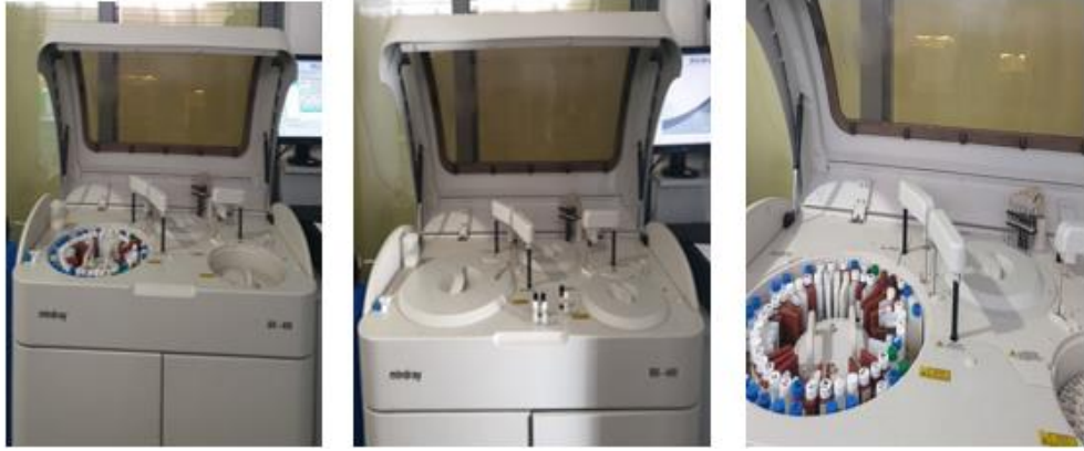
Şekil 2.48. Toplam Antioksidan ve Oksidan Aktivitesini Ölçen Cihaz (MINDRAY-BS400)
