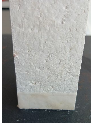
b. Numune yan yüzeylerine uygulanan parafin
