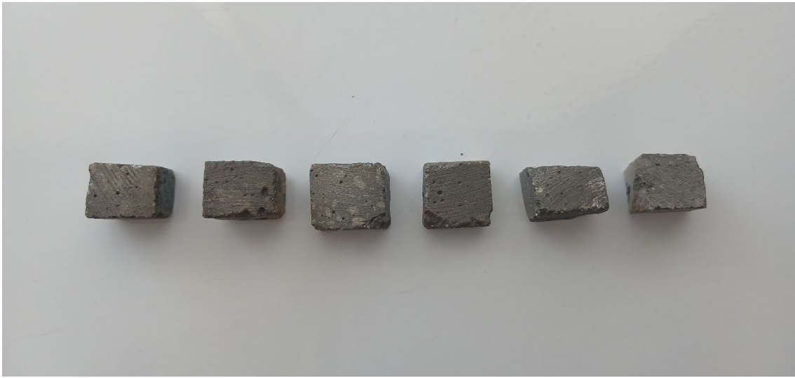
Şekil 3.24. Yüzeyleri altın/paladyum ile kaplanan numune örnekleri
