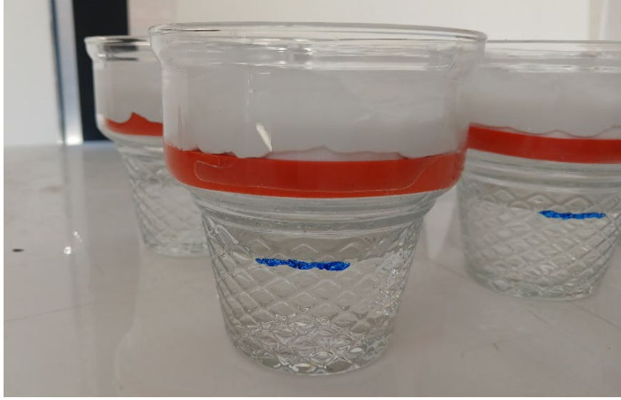
Şekil 3.18. Çözelti ile numune alt yüzeyi arasındaki boşluk
