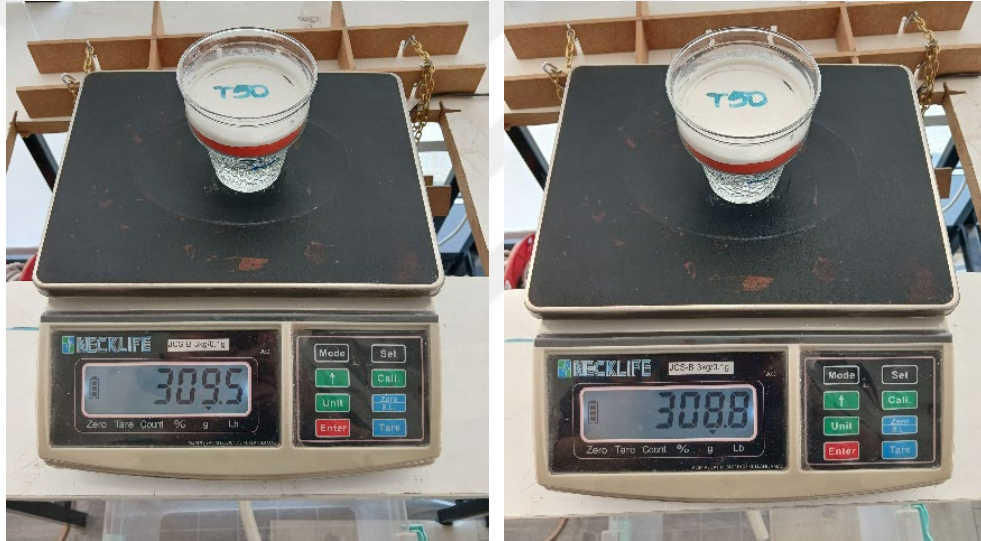
Şekil 3.19. T50 numunesinin 24 saat aralıklarla tartılması
