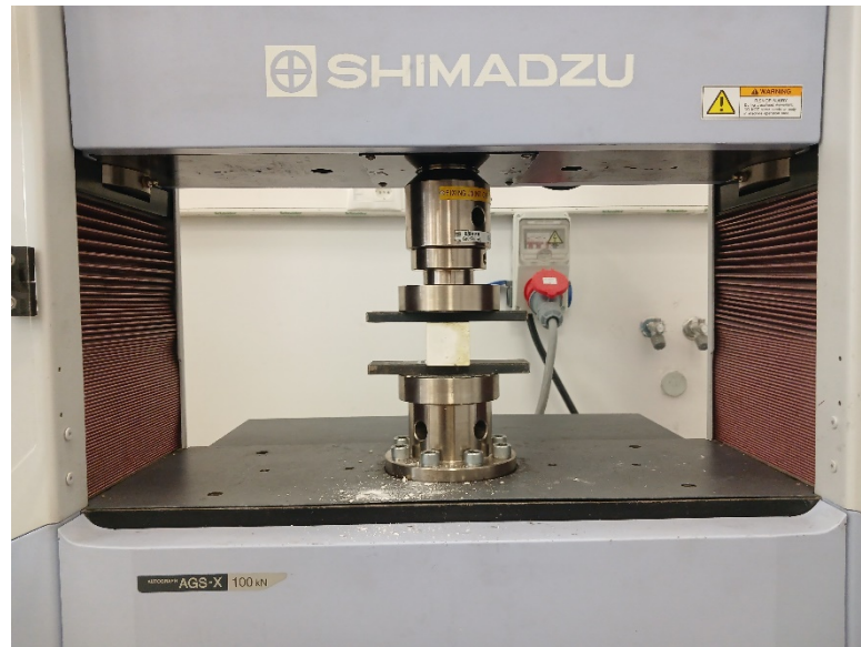
Şekil 3.22. Basınç dayanımı deneyinin uygulanması
