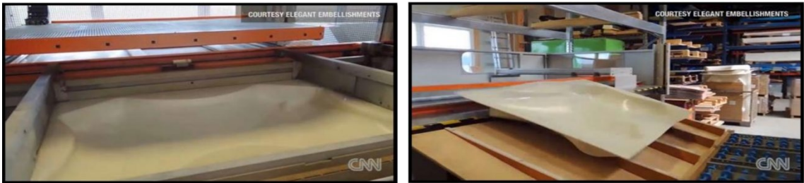
Şekil 2.13, 2.14. Prosolve370e Modüllerinin imalatı (Moafaq Al-Zaidi ve Sarkis Markaryan, 2020)
