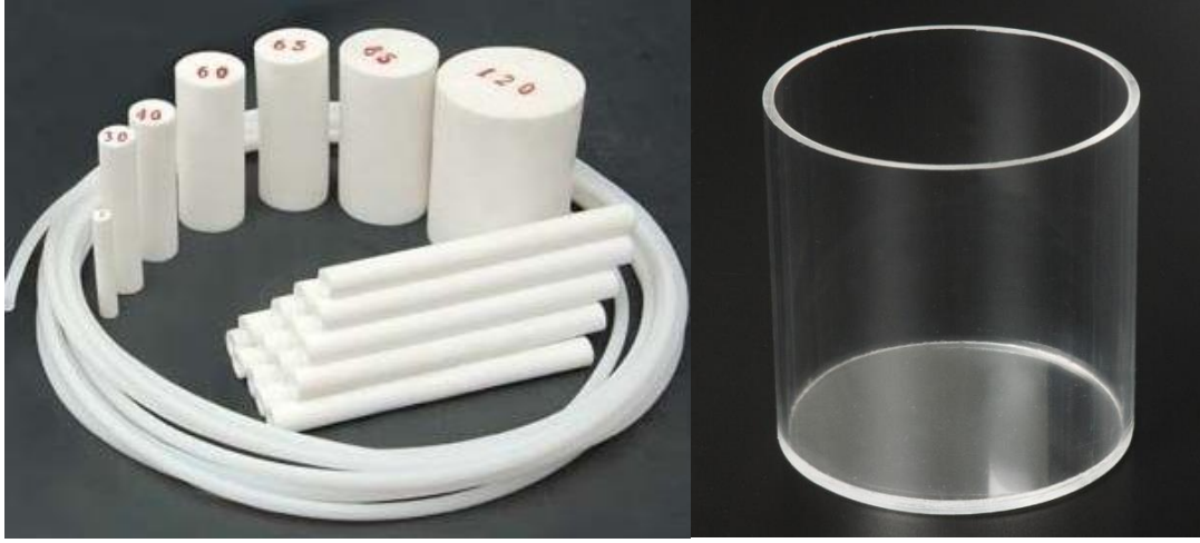
Şekil 2.10 : Değişik çap ve ebatlarda PE ve pleksiglas bloklar.
