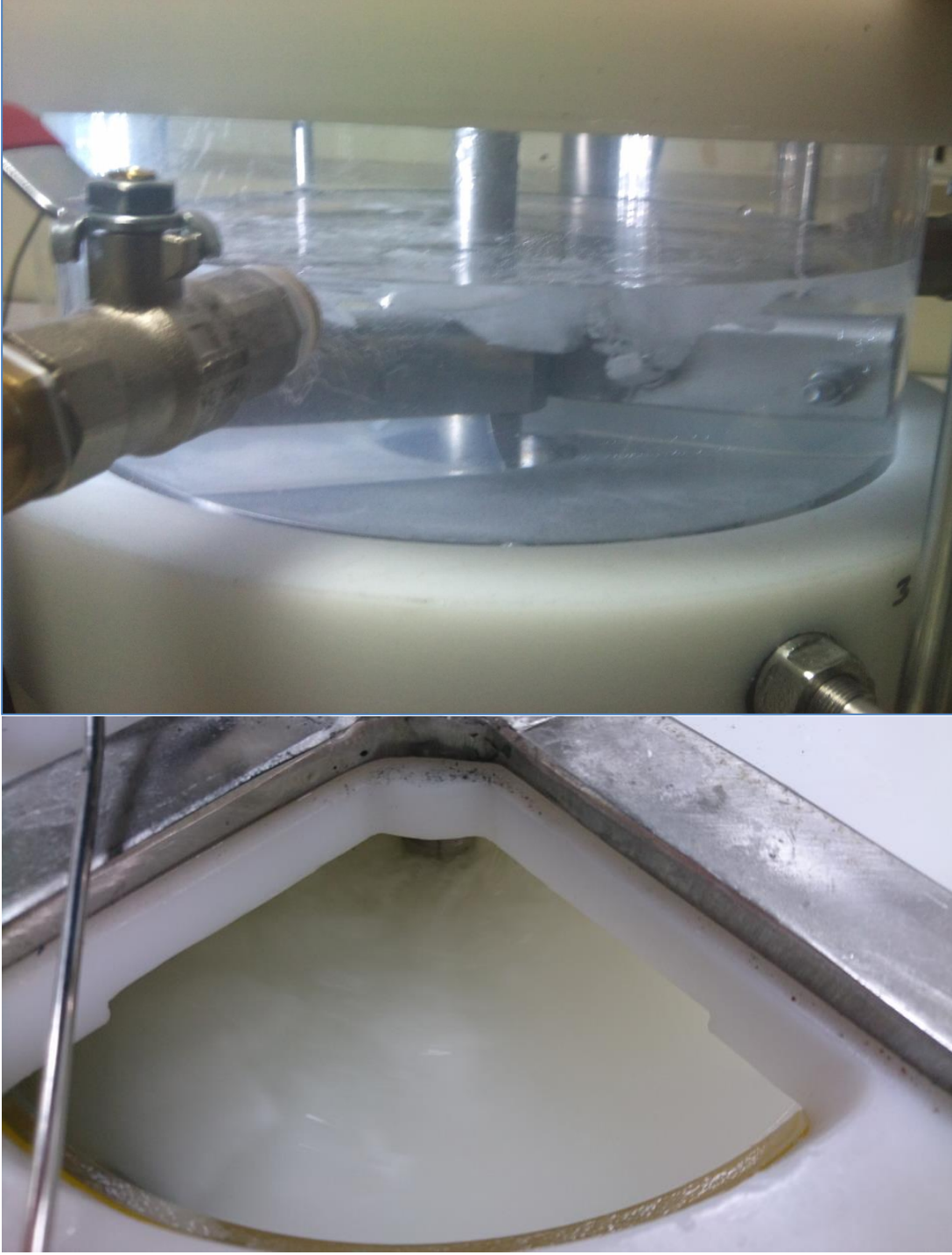
Şekil 2.21 : Ötektik kristalizör üst buz ayırma bölmesi/kapağı.
