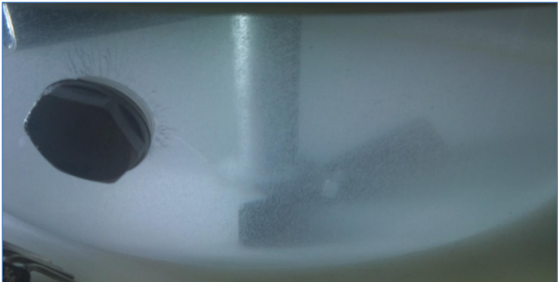
Şekil 2.20 : Ötektik kristalizör alt kristal toplama ve ayırma bölgesi.
