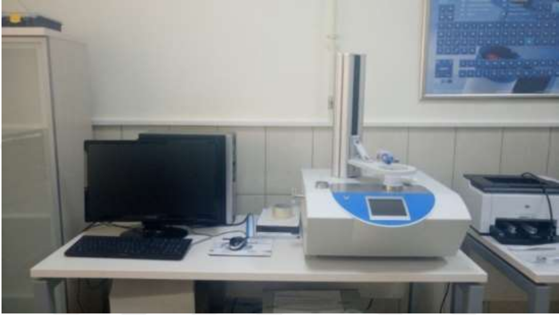
Şekil 2.2. Linseis STA PT1600 marka TGA cihazı
