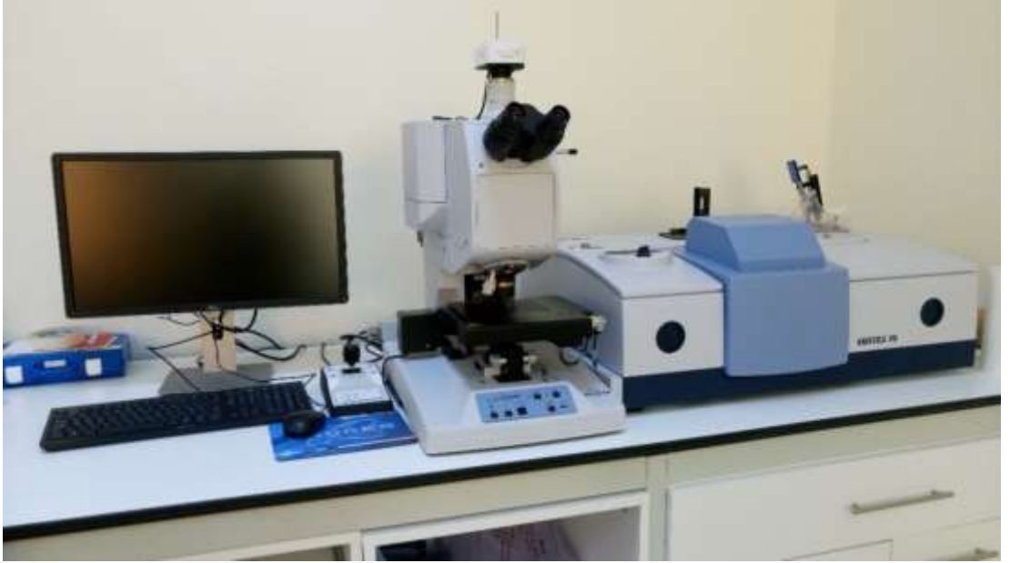
Şekil 2.1. Bruker marka Vertex 70 model FTIR spektrometresi
