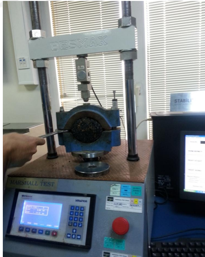
Şekil 2. 15 Marshall yükleme cihazı
