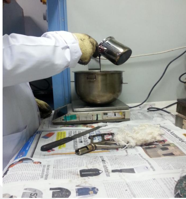
Şekil 2. 6 Agregalara bitüm ilave edilmesi
