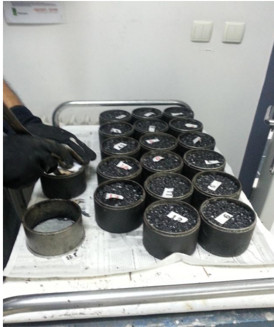
Şekil 2. 10 Hazırlanan Marshall briketleri
