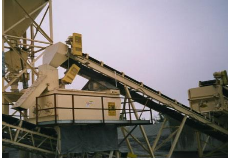
Şekil 1. 10 Sönmüş kirecin agregaya eklenmesi ve karıştırma ünitesinde karışımı [95]
