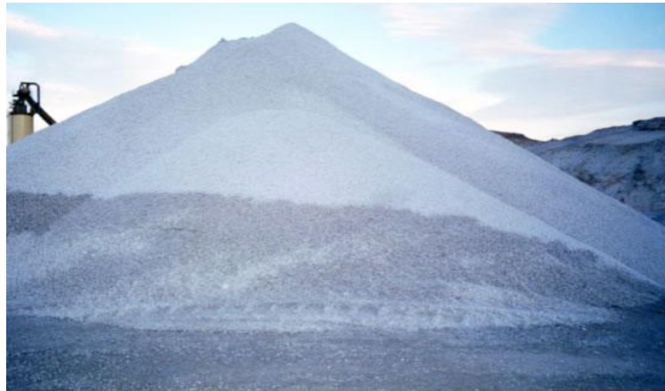
Şekil 1. 11 Depoda bekletilen sönmüş kireç harcı-agrega karışımı [95]
