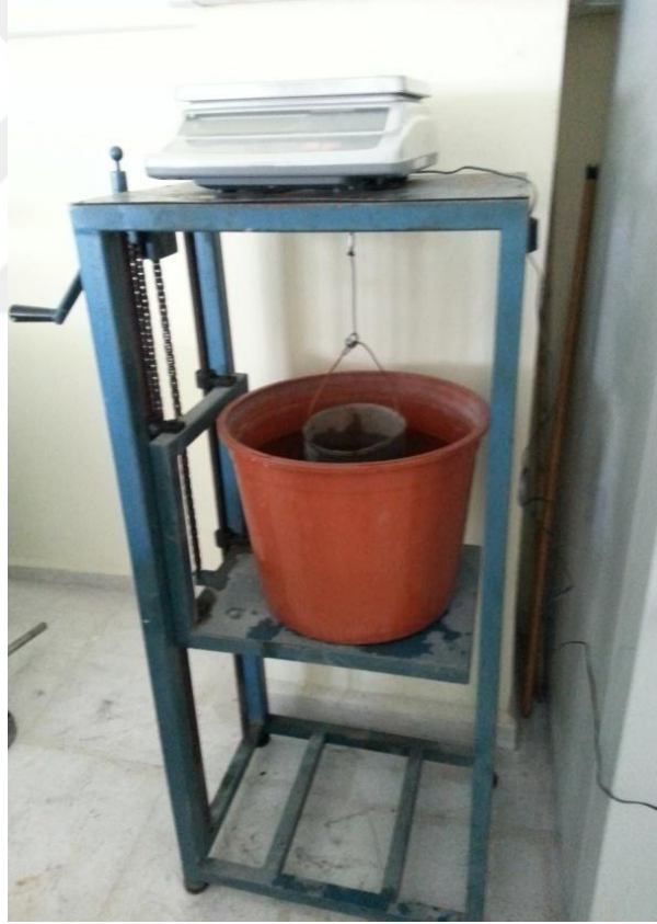
Şekil 2. 13 Sudaki ağırlık ölçümü
