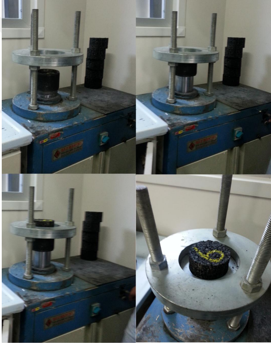
Şekil 2. 11 Numunelerin kalıptan çıkarılması
