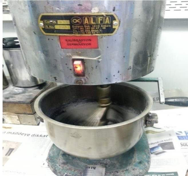
Şekil 2. 7 Agrega ile bitümün karıştırılması
