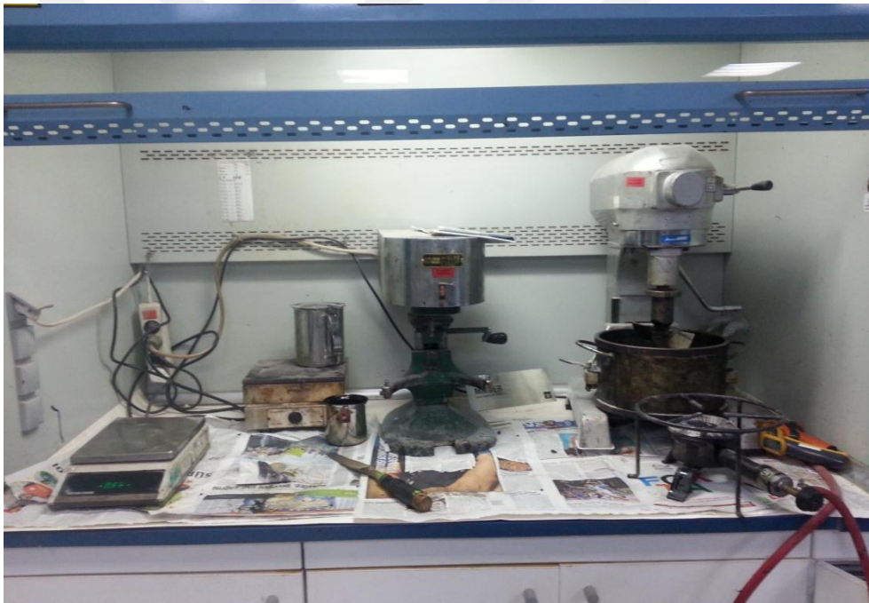
Şekil 2. 5 Agreg-a-bitüm karışımının hazırlanması
