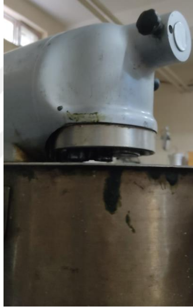
Şekil 12. Harç numunesinin karıştırıcıda karılması
