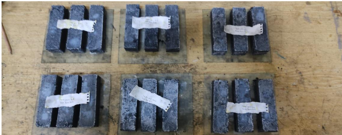
Şekil 13. Üretimi tamamlanmış harç numuneleri
