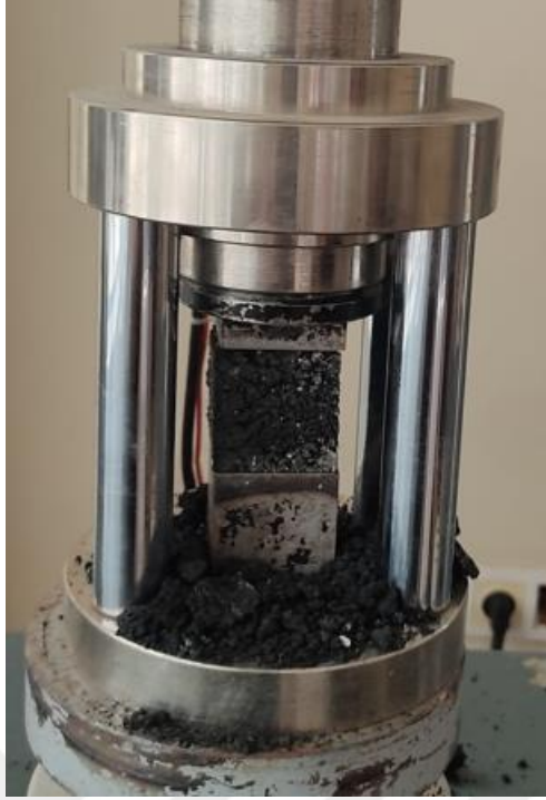
Şekil 20. Basınç dayanım deneyi yapılan harç numunesi
