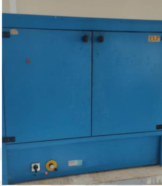
Şekil 14. Numunelerin etüve yerleştirilip 90°C’de bekletilmesi
