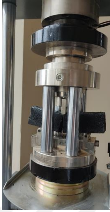
Şekil 19. Eğilme dayanım deneyi yapılan harç numunesi
