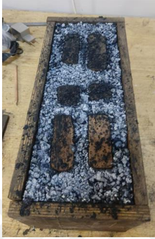
Şekil 18. Briket kalıbına yerleştirilen numune
