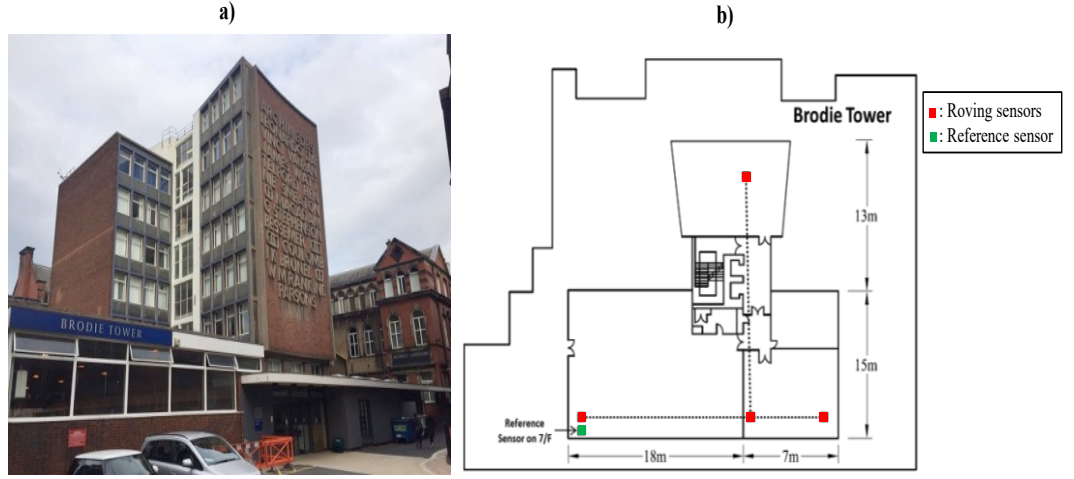
Şekil 5. 9. Brodie Tower'ın Görünümü ve Kat Seviyelerindeki Sensör Yerleşimi (Zhu et al.,2018)
