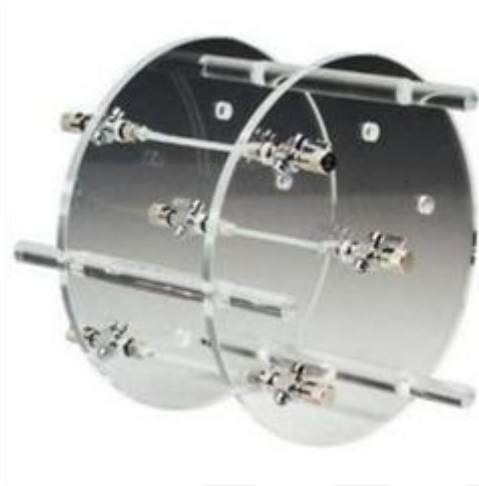
Şekil 3.15. Doldurulabilir üç adet kapiller tüp bulunan triple line insert fantomu (13)
