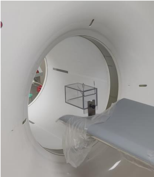
Şekil 3.28. PET/BT cihazında ^{68}\text{Ge} çubuklarının konumlandırılması
