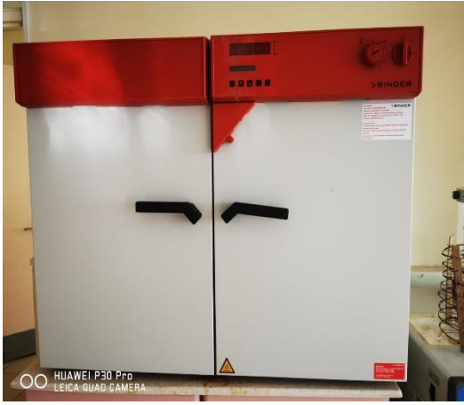
Resim 3.18. Yemlerde kuru madde (Etüv Binder Marka)
