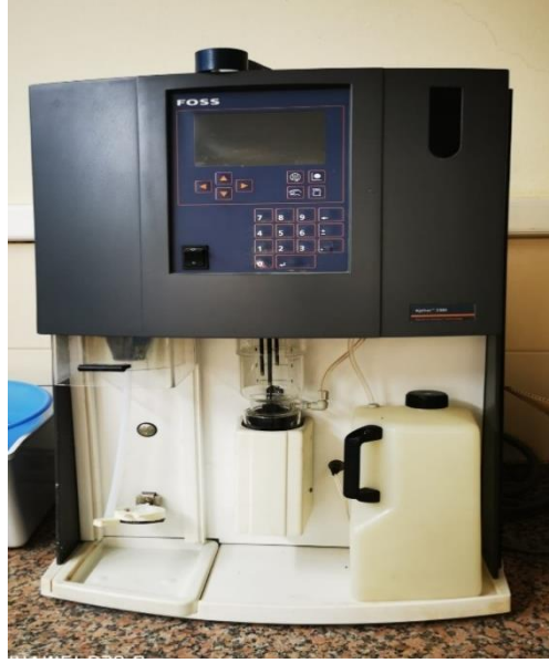
Resim 3.22. Yemlerde ham protein tayini (Foss Marka Protein Cihazı)
