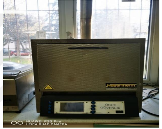
Resim 3.19. Yemlerde ham kül tayini (Kül Fırını tayini Nabertherm Marka)
