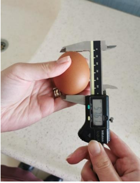
Resim 3.23. Yumurta En-Boy Ölçümü (Kumpas-Mitutoyo Marka)
