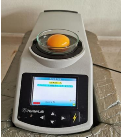
Resim 3.27. Sarı Yoğunluk Ölçümü (Hunterlab-Colorflex)
