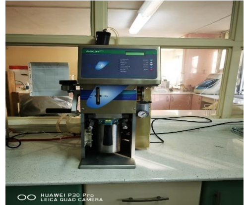
Resim 3.21. Yemlerde ham yağ tayini (Ankom Marka Ham Yağ Cihazı)
