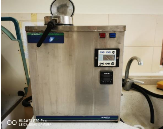
Resim 3.20. Yemlerde ham selüloz tayini (Ankom Marka)
