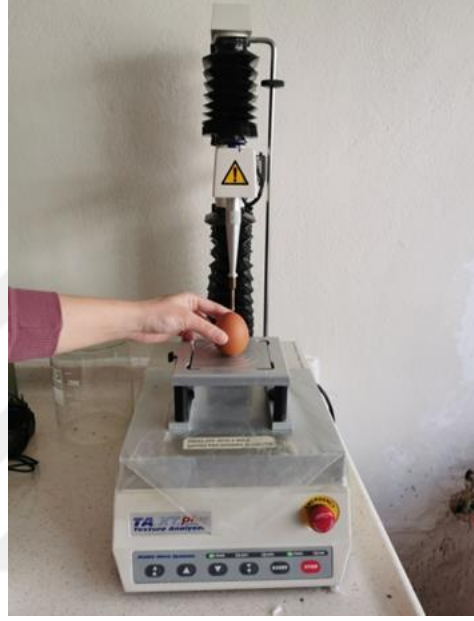
Resim 3.24. Kırılma Direnci Ölçümü (Tekstür cihazı TA.XT.plus marka)
