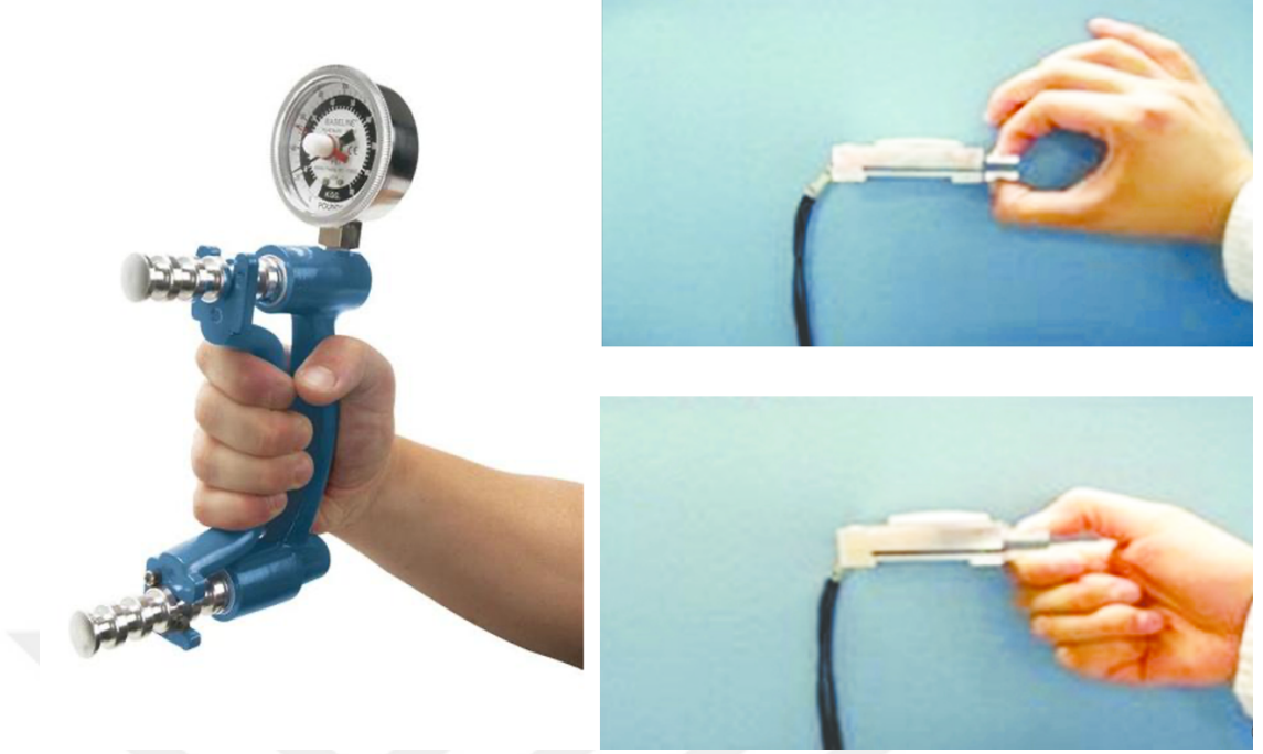
Şekil 9: Testlerin Dinamometre ile Ölçülme Pozisyonları
