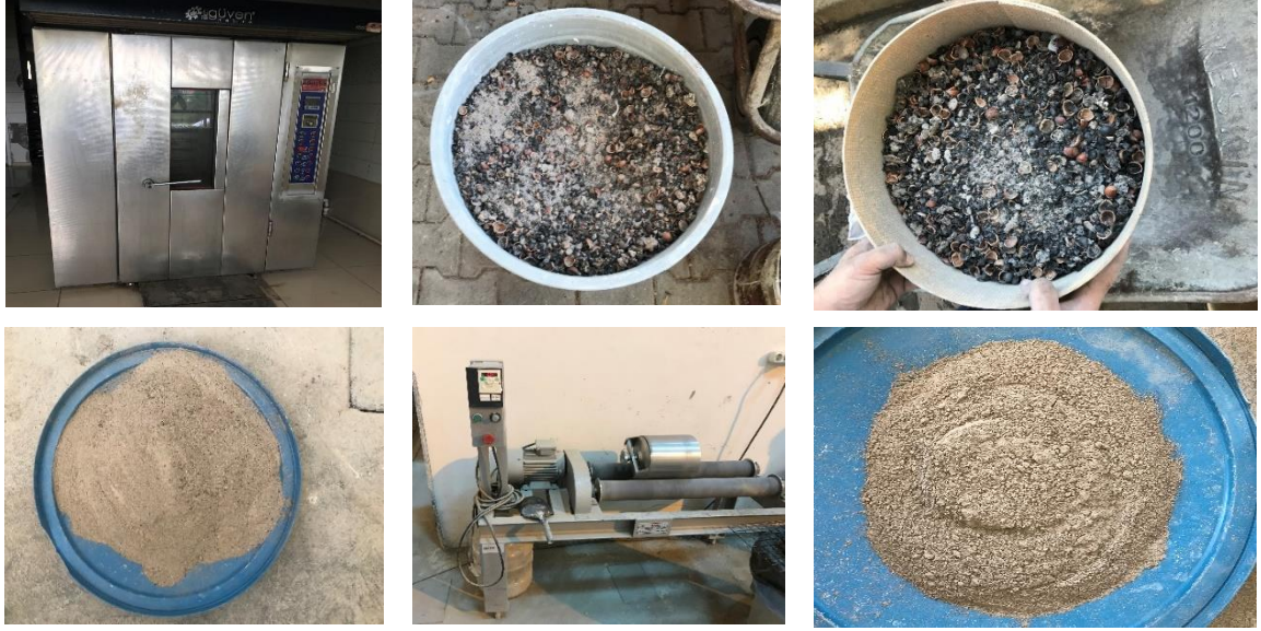
Şekil 3.3 Öğütülmüş külün elde edilme aşamaları
