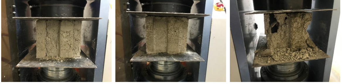
Şekil 3.15 Basınç deneyi sonrası kırılan bimsler
