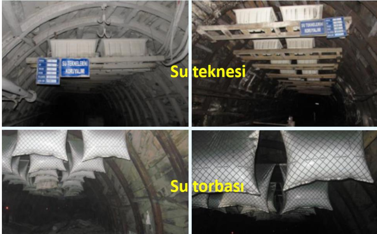
Şekil 2.17 Su torbaları ve su tekneleri ile pano giriş ve çıkışlarına yapılan barajlar (Erbay 2016).
