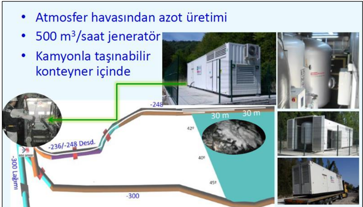
Şekil 5.1 Ayak arkasına azot ve one-seven köpük uygulaması (Erbay 2016).
