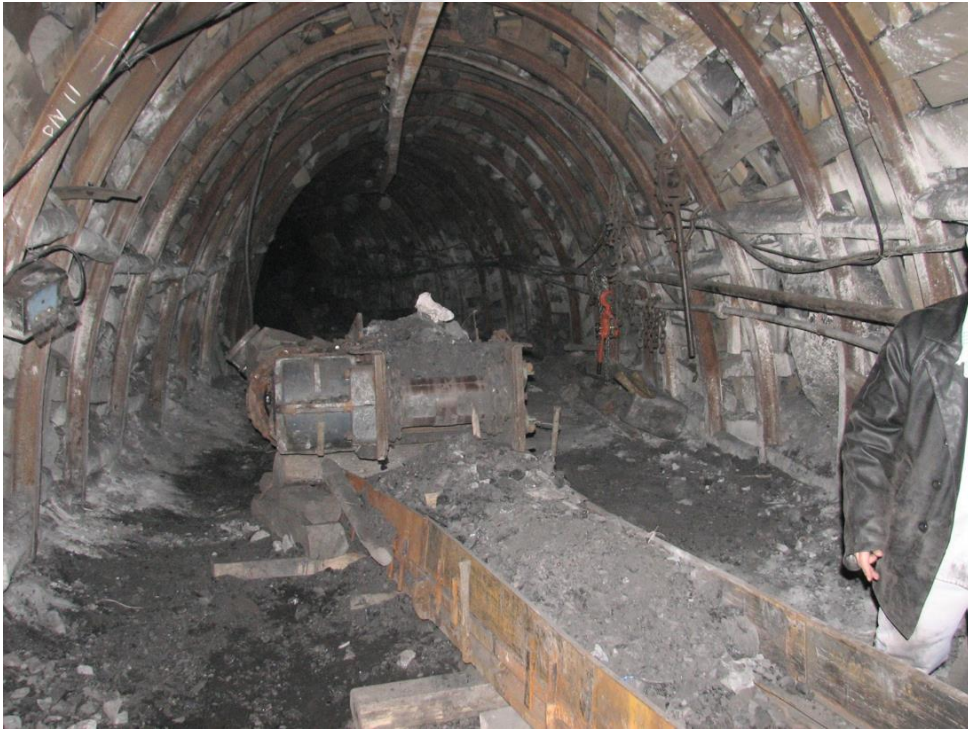
Şekil 4.13 Ayak alt taban yolunda kurulu olan zincirli konveyör.
