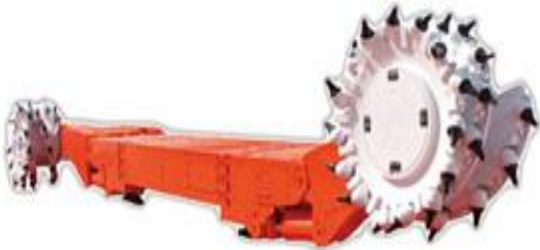
Şekil 2.7 Xintie madeninde kullanılan kesici makine (Tu et al. 2017).
