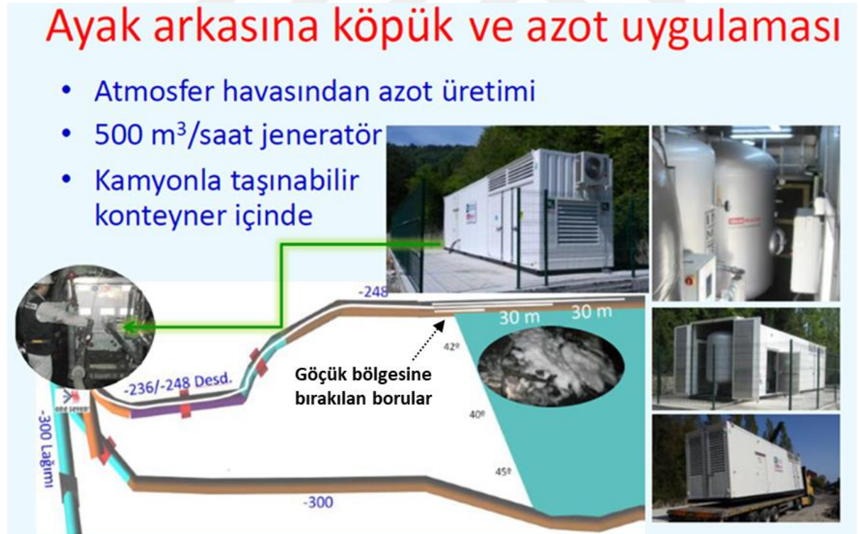
Şekil 2.16 Mekanize ayak arkalarına düzenli basılan azot-köpük uygulaması (Erbay 2016).
