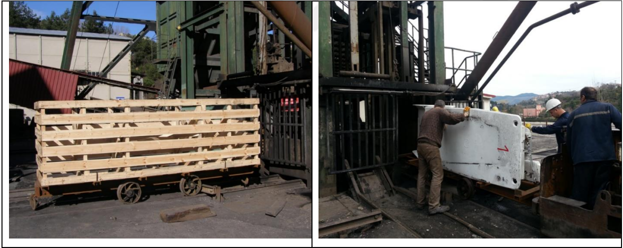
Şekil 4.12 Şiltler için yapılan maket ve şiltin kafes sistemi ile ocağa gönderilmesi.
