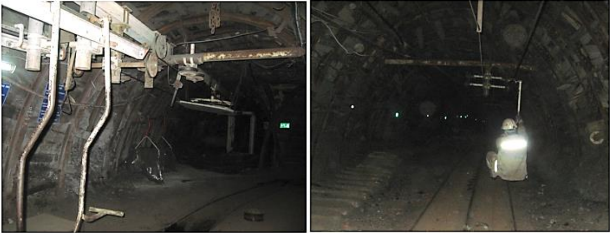
Şekil 2.22 Telesiyej insan taşıma ünitesi.
