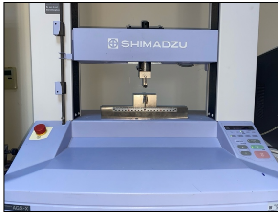
Resim 15. Shimadzu üç nokta eğme testi ölçüm cihazı
