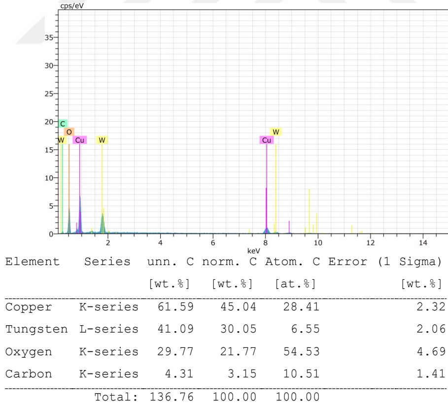
Şekil 4.2 5. Deneyde Sentezlenen CuO nanoparçacık EDX analizi
