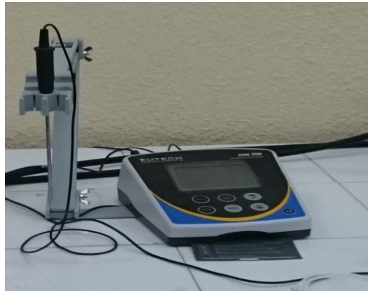
Resim 3.3 Deney esnasında kullanılan PH metre ve termometre cihazı
