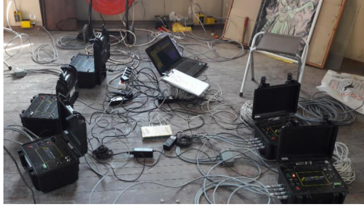
Şekil 5.16. Deneysel çalışmada kullanılan veri toplama sistemi
