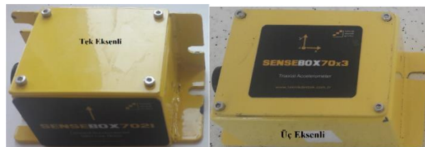
Şekil 5.12. DeneySEL çalışmada kullanılan tek ve üç eksenli ivmeölçerler
