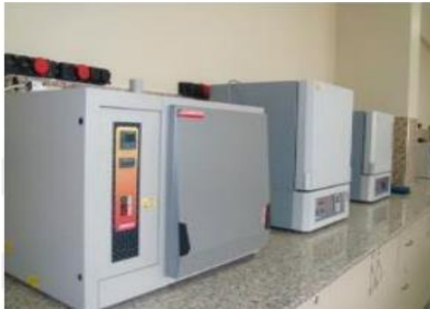
Şekil 3.10. Borlama işlemi için kullanılan ısıtım fırınları.
