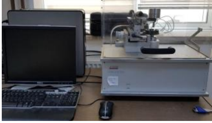
Şekil 3.13. CSM Instrument Tribometer ball on disk aşınma testi cihazı.
