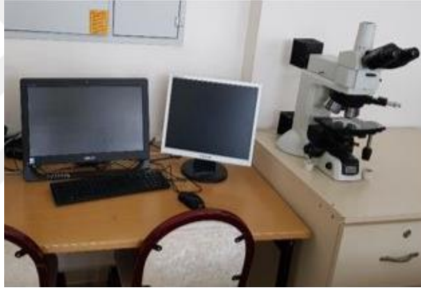
Şekil 3.9. Nikon LV 100 marka optik mikroskop.
