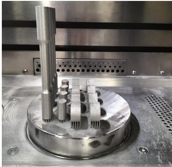
Şekil 3.3. Inconel 718 deney numunelerinin SLE cihazında üretildikten sonraki görüntüleri.
