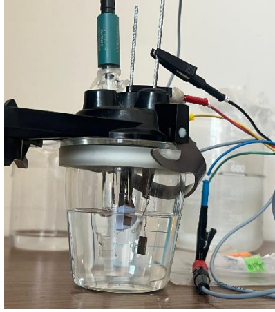
Şekil 3.12. Korozyon ölçümü için kullanılan düzenek.
