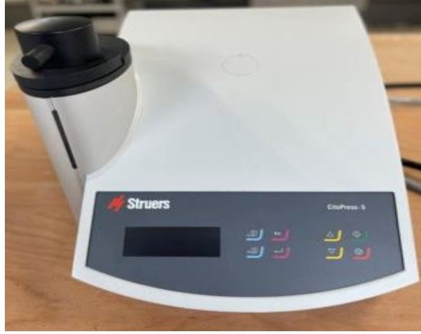
Şekil 3.8. Struers CitoPress-1 otomatik bakalite alma cihazı.
