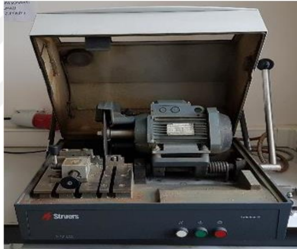
Şekil 3.7. Struers Labotom-3 masa üstü numune kesme cihazı.
