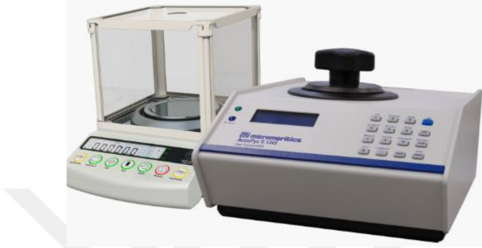
Şekil 3.4. Micromeritics AccuPyc II 1345 gaz piknometre yoğunluk ölçüm cihazı.
