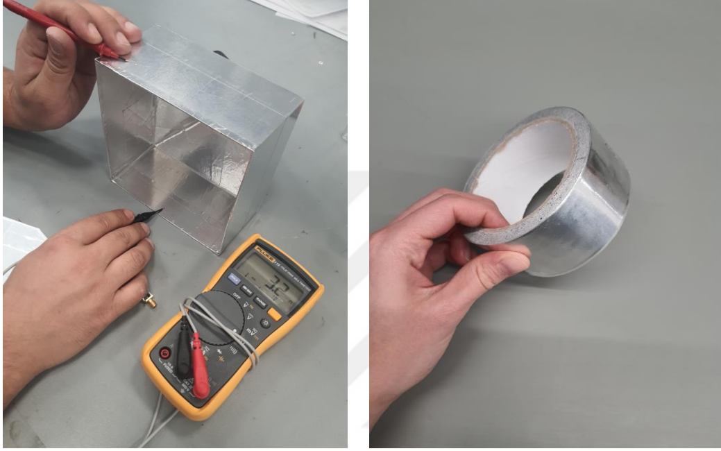
Şekil 5.8. Alüminyum bant ile kaplanmış büyük TEM-t hücresinde iletkenlik ölçümü.
