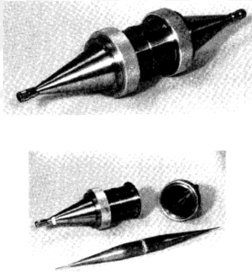
Şekil 3.5. Sürekli İletken Dairesel Eş Eksenli Tutucu [12].
