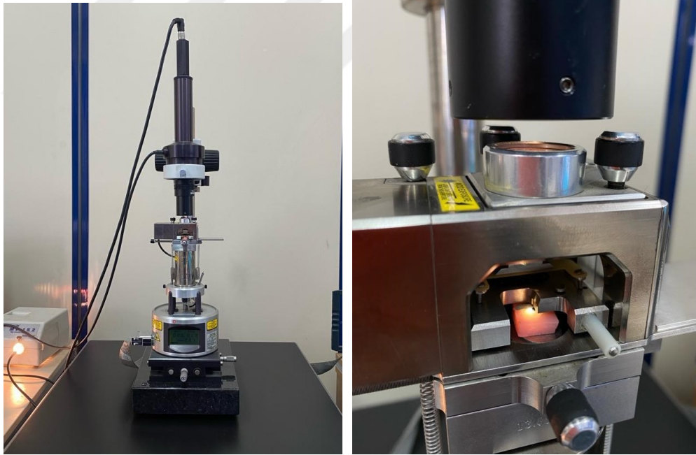
Şekil 2.9. Diş örneklerinin AFM ile taranması
