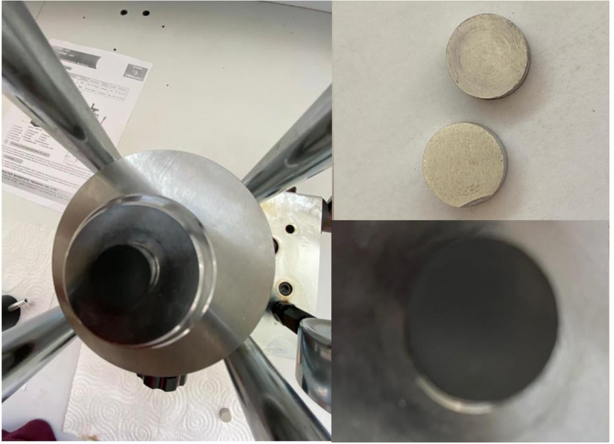
Şekil 31. Pelletleme sırasında die-setin kendisinin presteki yerleşiminin dengesiz ve kullanılan die-setin kusurlu olduğu durumlarda alaşım üretiminde başarısız olduğunu gösteren fotoğraflar
