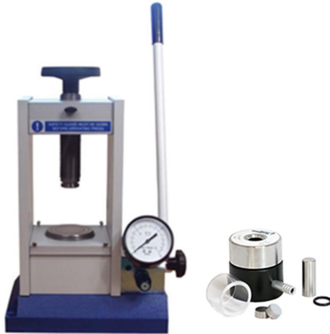
Şekil 24. Numuneleri şekillendirmek için kullanılan hidrolik pres ve 13 mm çapında dia-set
