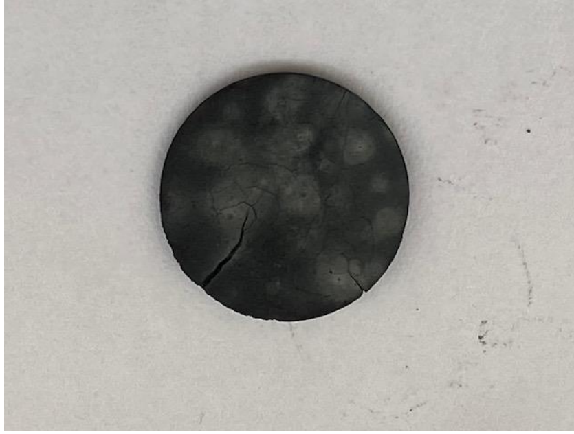
Şekil 33. İyi planlanmamış bir sinterleme işleminin \text{Co}_2\text{Mn}_x\text{Ni}_{1-x}\text{Al} ( x = 0,4 ) alaşımında sebep olduğu yapısal problemleri gösterir fotoğraf.
