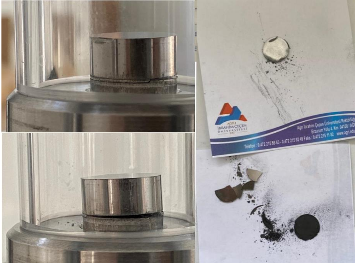
Şekil 30. Pelletleme sırasında die-setin içerisindeki preslenecek tozun düzgün dağılmadığı durumlarda alaşım üretiminde başarısız olduğunu gösteren fotoğraflar
