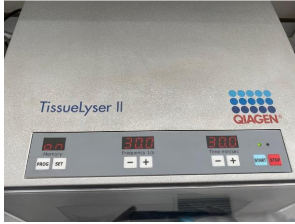
Şekil 23. Toz karışımlarının homojenizasyonu için kullanılan karıştırıcı
